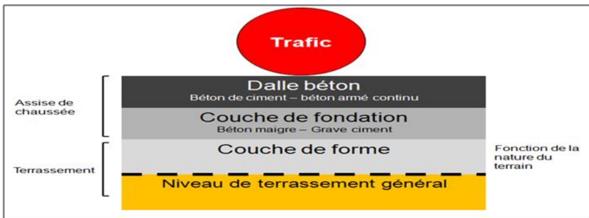
Figure VII.3 : Structure type d'une chaussée rigide.
