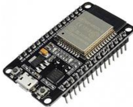
Figure II-20- Image d'un ESP32.
