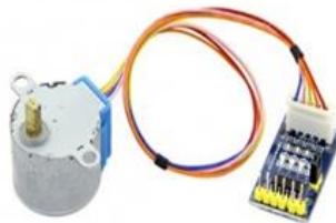
Figure II-18- Image d'un moteur pas à pas.
