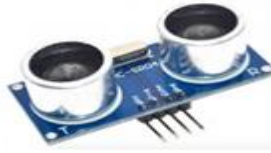
Figure II-23- Image d'un ultrason.
