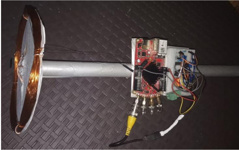
FIGURE III.3 – Montage électrique de l'appareil de mesure réalisé.
