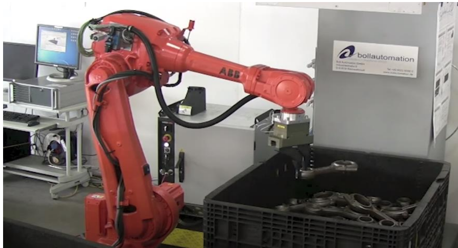
Figure II.4: Robot industriel de la manipulation des pièces [29].
