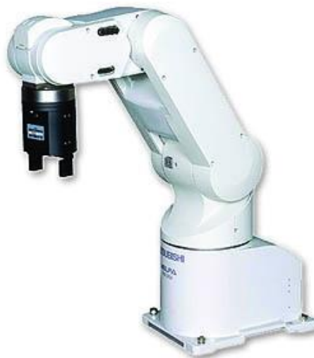
Figure I.1 : Robot sériel (Robot RV-2AJ de Mitsubishi).
