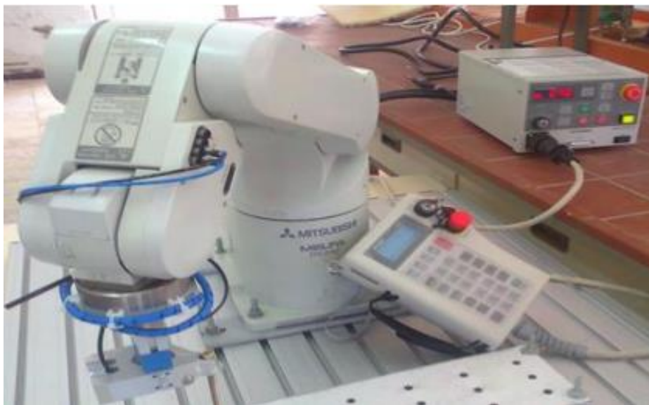
Figure II.9: boîte à boutons pour l'apprentissage du robot.
