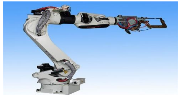
Figure I.11: Robot anthroporphe (Kawasaki) [28].
