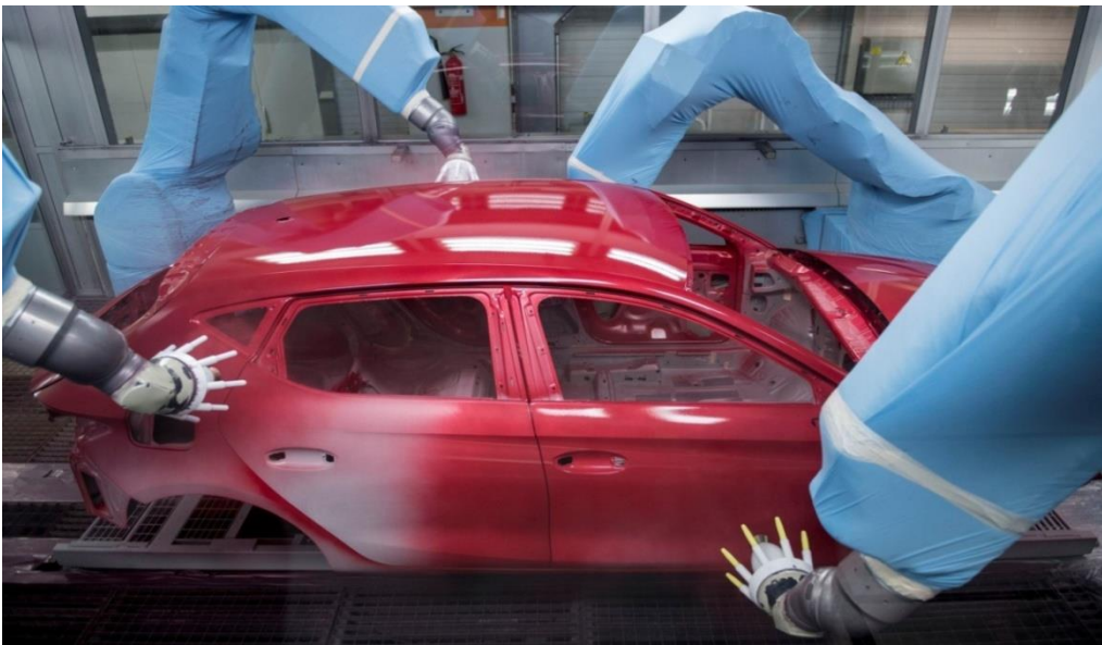
Figure II.3: Robot industriel du Peinture [19].
