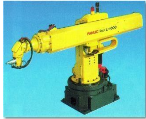
Figure I. 10: Robot sphérique (Fanuc) [28].
