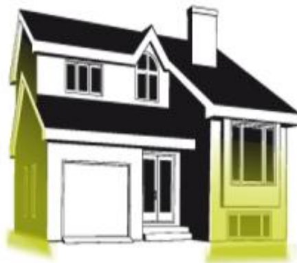
Figure 17 Eclairage lèche mur avec projecteur encastré de sol [24]
