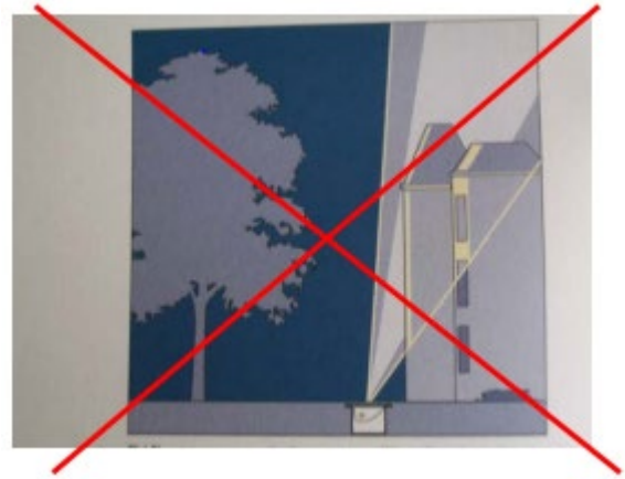
Figure 57 : mauvais positionnement d'un luminaire
