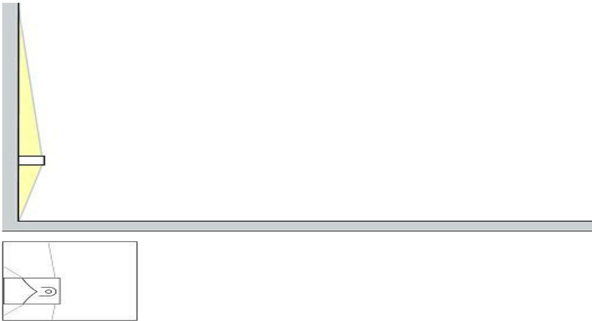
Figure 63 : Positionnement idéal pour placement d'une applique LED
