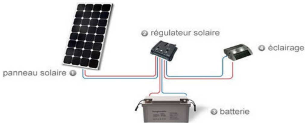
Fig. III.11 Modèle d'installation PV avec régulateur MPPT
