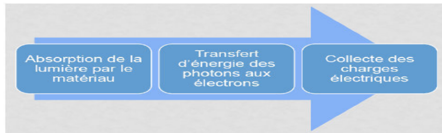
Fig.( I.8) Les trois mécanismes de transformation de l'énergie solaire en énergie électrique.
