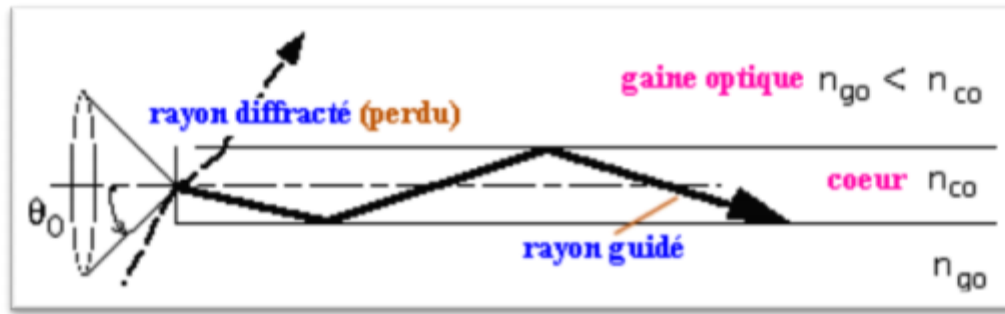
Figure I.9 : l'ouverture numérique d'une fibre optique
