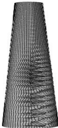
**Figure I.6.** Évaluation du flambement de pipe conique sous pression axiale.
