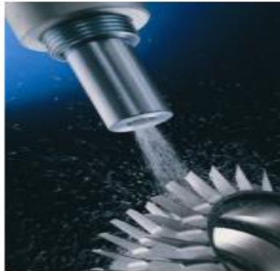
Figure II.2.Exemple d'une buse de grenailleuse à air comprimé [15]
