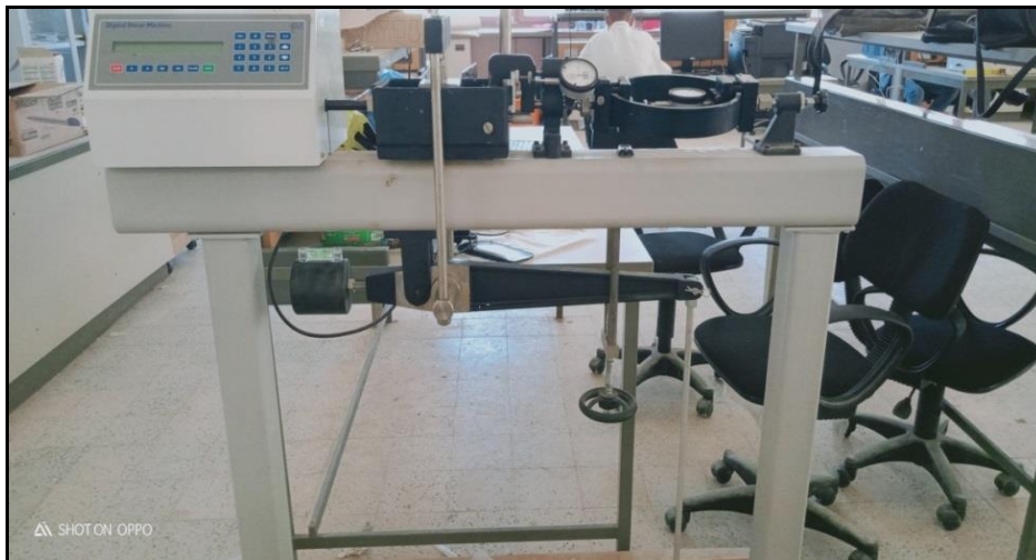
Figure IV.20 : Appareil de cisaillement (laboratoire LNPC-université de MOSTAGANEM)
