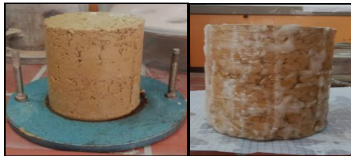
Figure IV.15: Essai Proctor (a) échantillon confectionné (b) échantillon paraffiné pour stockage
