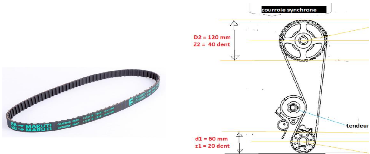
FIGURE 18 : courroie crantée d'un maruti[4]
