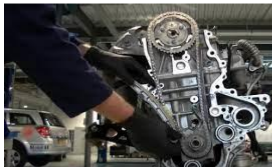
FIGURE 15 : chaîne de distribution dans un moteur thermique [4]
