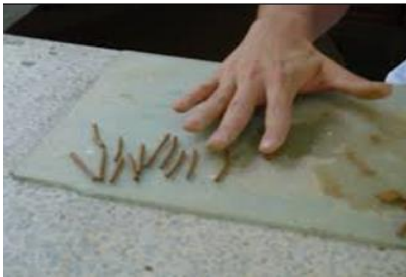
Figure 25: Limite de plasticité.
