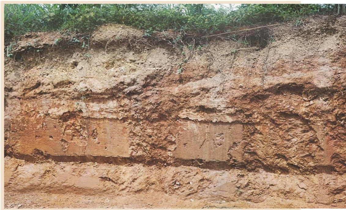
Figure 12: Vue panoramique d'une fouille présentant la nature lithologique Terrain traversé par le tracé à proximité du douar el Homr. Il s'agit d'une argile alluvionnaire, rougeâtre à marron clair, renfermant à la base des concrétions carbonatées blanchâtres d'origine diagénétique. Cette argile s'achève par une terre végétale de faible épaisseur
