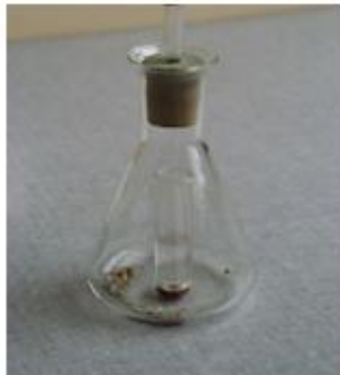
Placer l'échantillon dans la fiole
