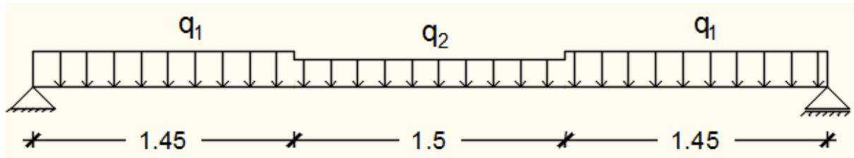
**Fig. IV.1.16** : Schéma statique de la poutre brisée.
