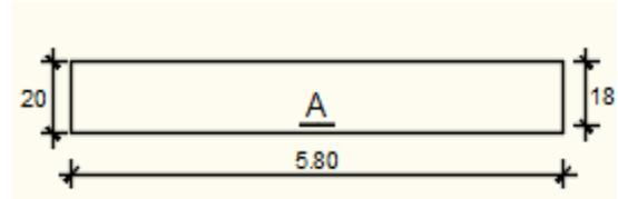
**Fig.VIII.6:** Section du calcul de voile suivant l'axe y-y.
