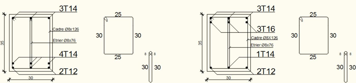
**Fig.VII.5:** Ferrailage des poutres secondaire
