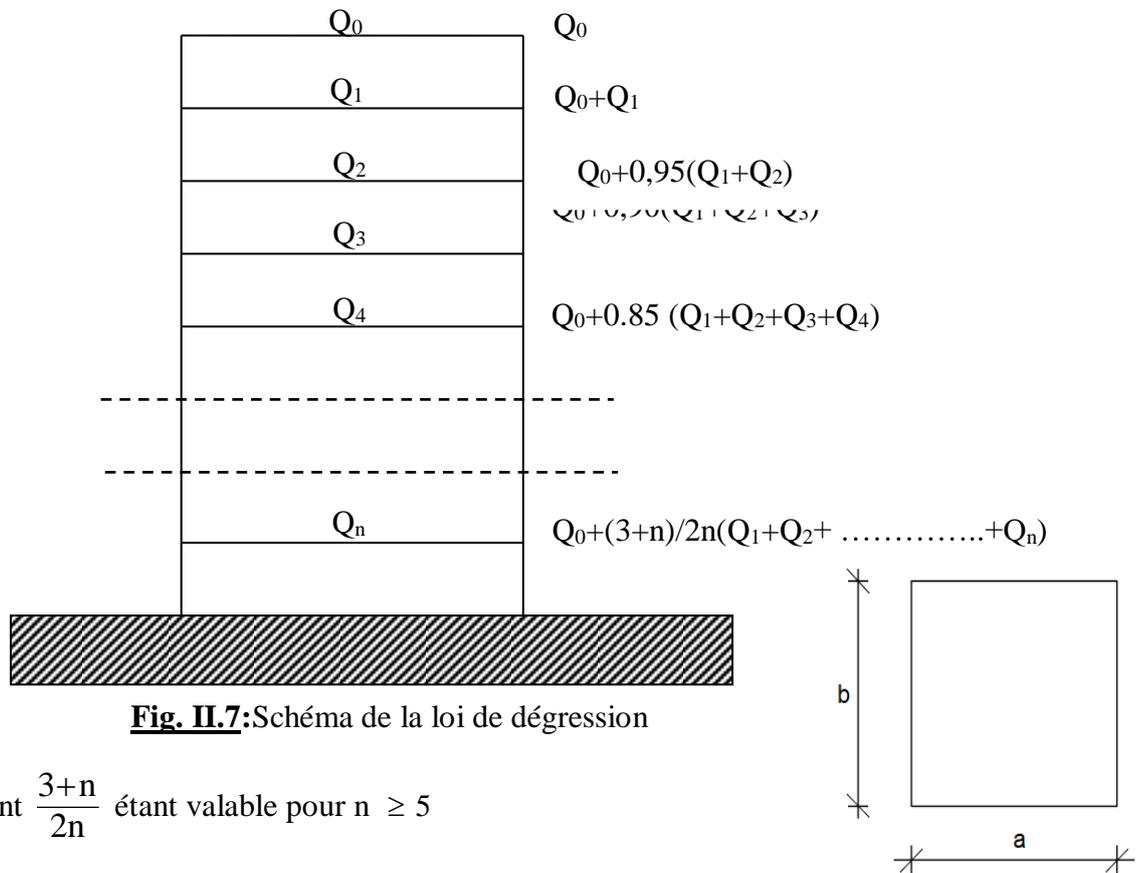
**Fig. II.7:** Schéma de la loi de dégression
