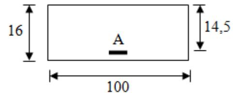
**Fig. III.20 :** Section de calcul en travée (x-x)
