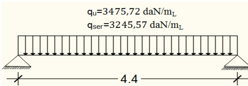
**Fig.IV.1.31** : Schéma statique de la poutre palier.
