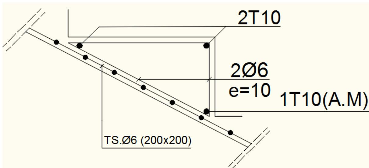
**Fig.IV.1.8** : Coupe transversale sur la marche porteuse.
