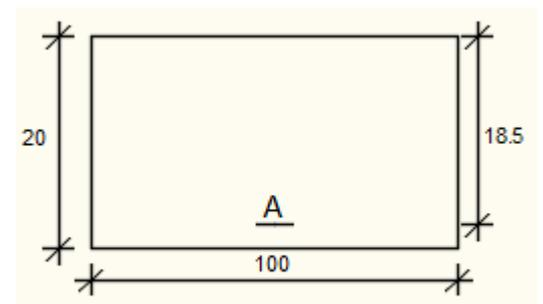
**Fig. V.6 :** Section de calcul en travée (x-x).
