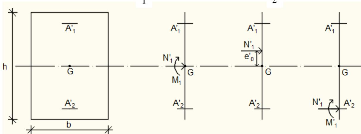
**Fig.VII.7:** Position de  $N'_1$   $M'_1$  et  $M_1$  sur la section transversale.
