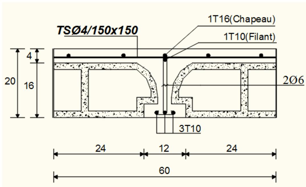
**Fig.III.11:** Coupe transversale d'un plancher à corps creux.
