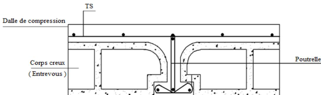
**Fig.III.1** : coupe transversale d'un plancher à corps creux.
