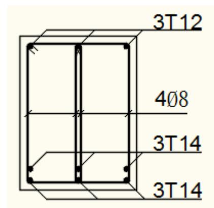
**Fig. IV.1.35** : Armatures longitudinales et transversales.
