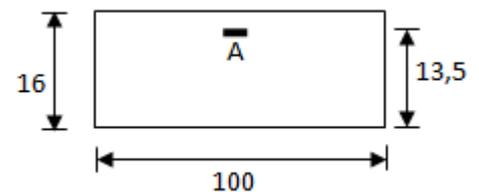
**Fig. III.23** : Section de calcul en appuis (y-y)
