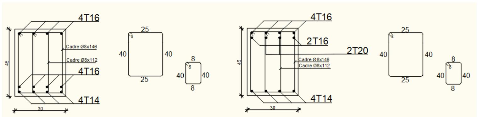
**Fig.VII.4 :** Ferrillage des poutres Principales.
