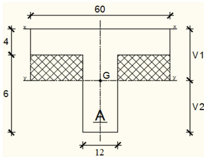
**Fig.III.12** : Section de calcul
