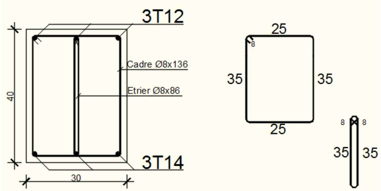
**Fig.IV.1.37:** Dessin de ferrailage de la poutre palier en appuis.
