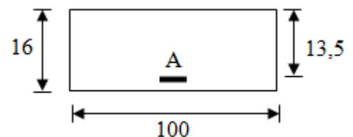
**Fig. III.22** : Section de calcul en travée (y-y)
