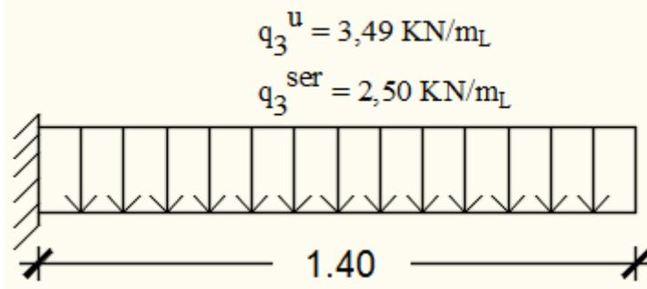
**Fig.IV.1.6 :** Schéma statique de la marche porteuse.
