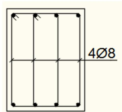
**Fig. VII. 3:** Armatures transversales.
