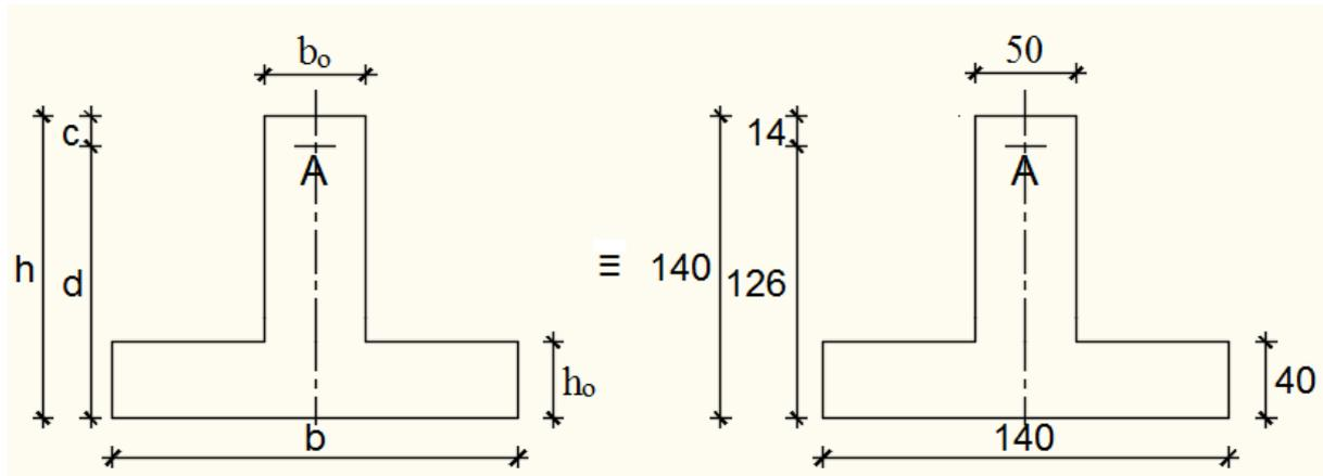
**Fig. IX.16 :** Section de calcul.
