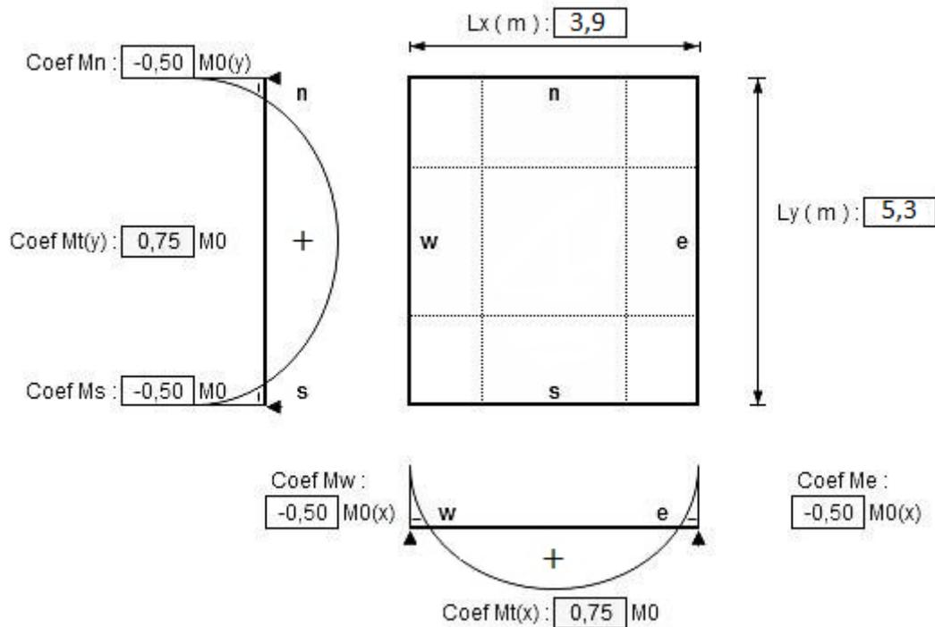
**Fig. III.19** : Schéma statique d'un panneau(8).
