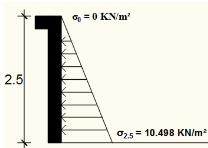
**Fig.VIII.9** : Schéma des contraintes de voile périphérique.
