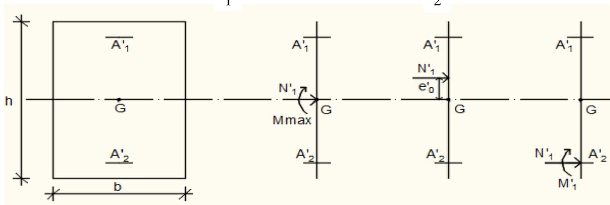
**Fig.VIII.5:** Position de  $N'_1$   $M'_1$  et  $M_1$  sur la section transversale.
