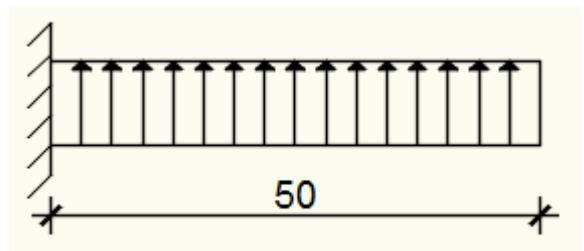
**Fig.IX.11** : Schéma statique du débordement.
