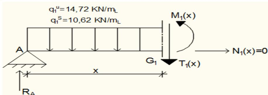
**Fig. IV.1.11:** Schéma statique pour calcul des efforts.
