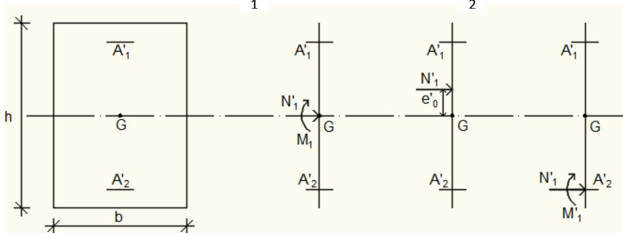
**Fig.VII.12:** Position de  $N'_1$   $M'_1$  et  $M_1$  sur la section transversale.
