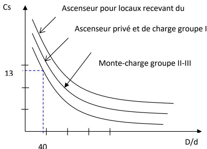
**Figure V.3 :** Abaque de détermination de suspentes.
