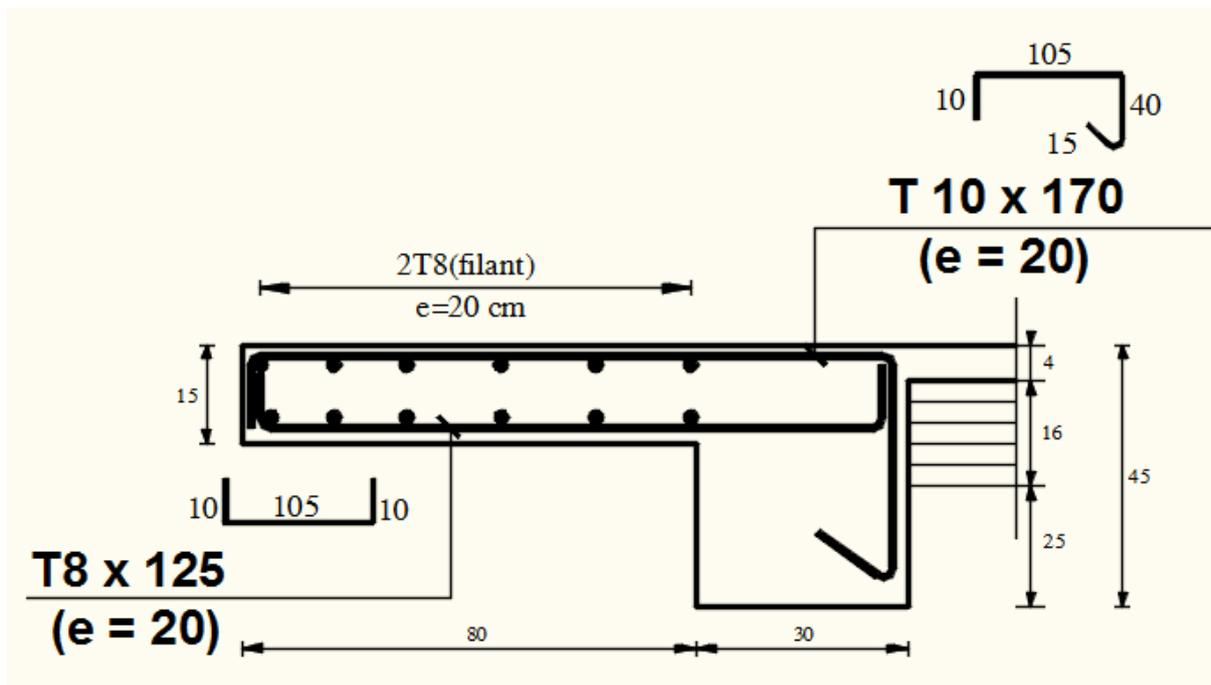
**Figure IV.2.8** : Schéma de ferrailage balcon type 2.
