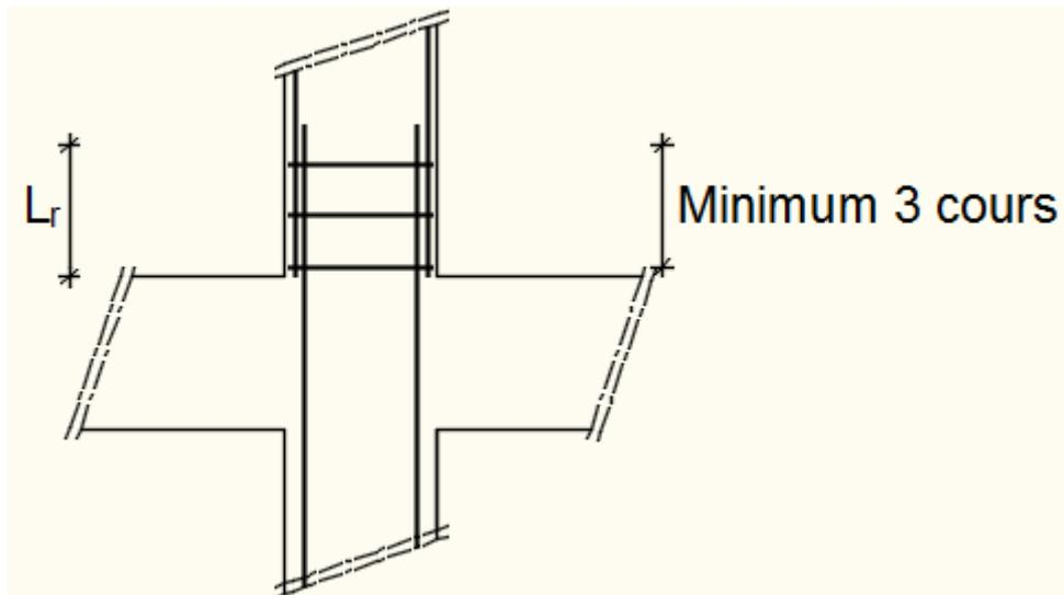
**Fig. VII.9:** Armatures transversales dans la zone de recouvrement.
