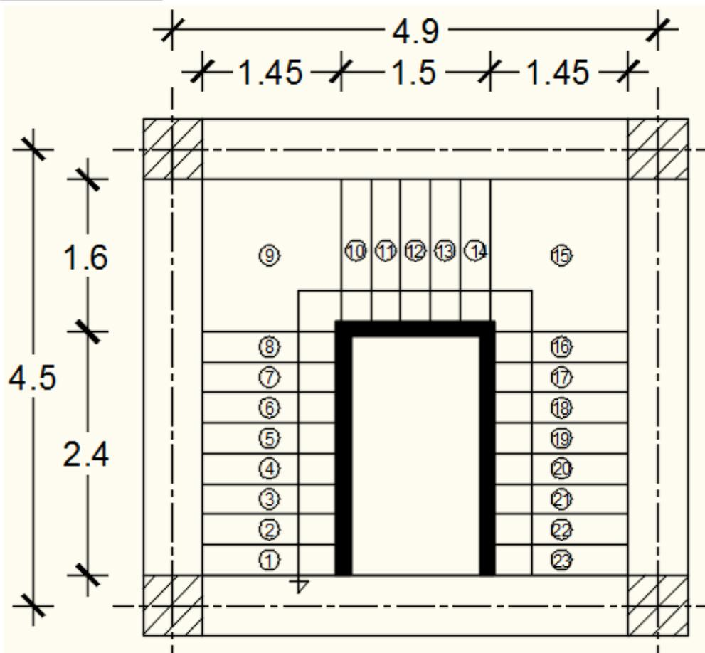
**Fig. IV.1.3 :** Vue en plan de la cage d'escalier type1.
