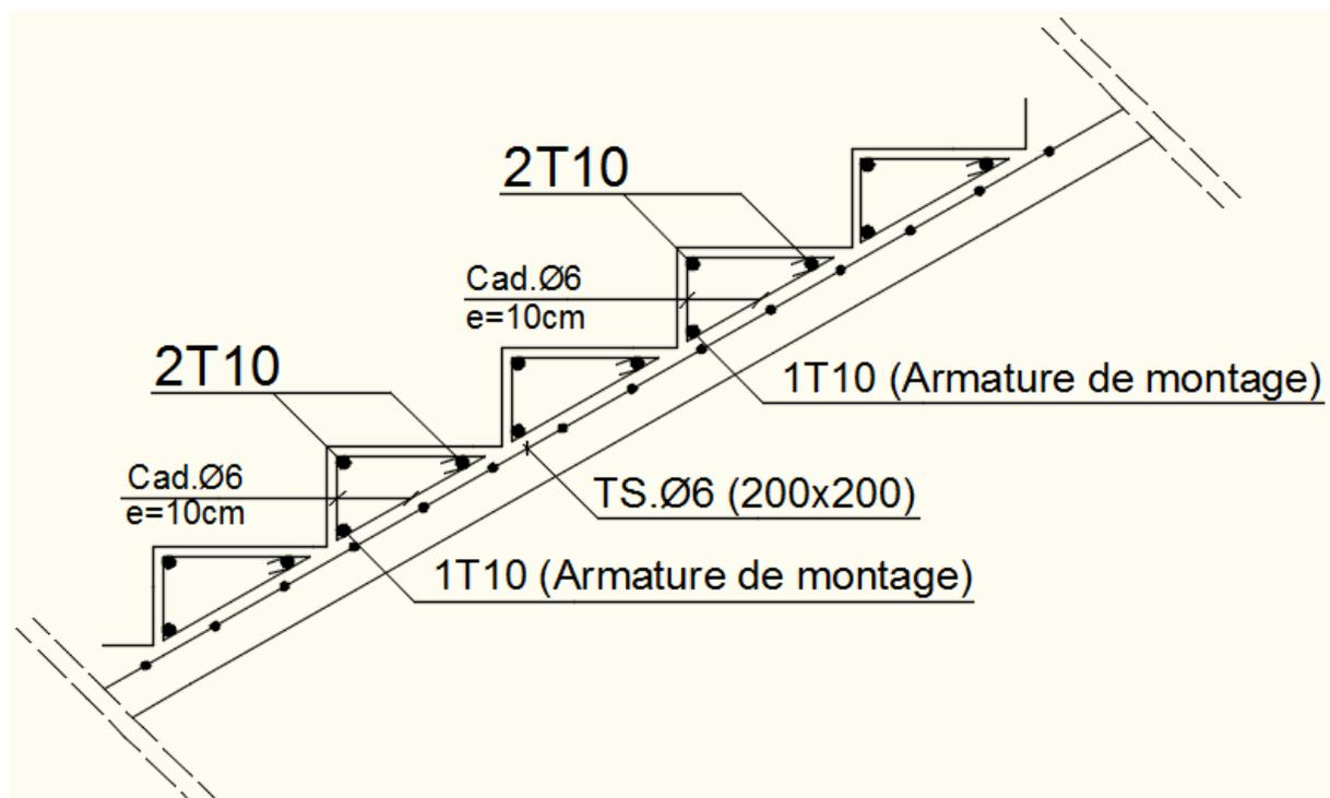
**Fig.IV.1.9 :** Dessin de ferrailage de la marche porteuse.
