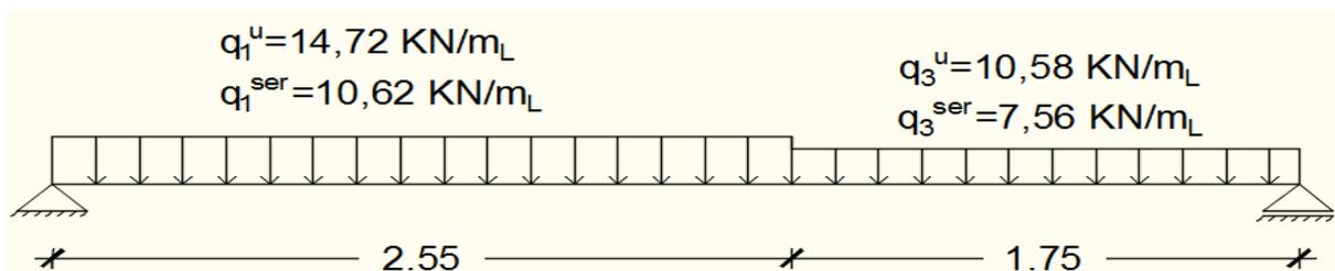
**Fig.IV.1.26 :** Schéma statique d'un escalier a paillasse avec palier de repos.
