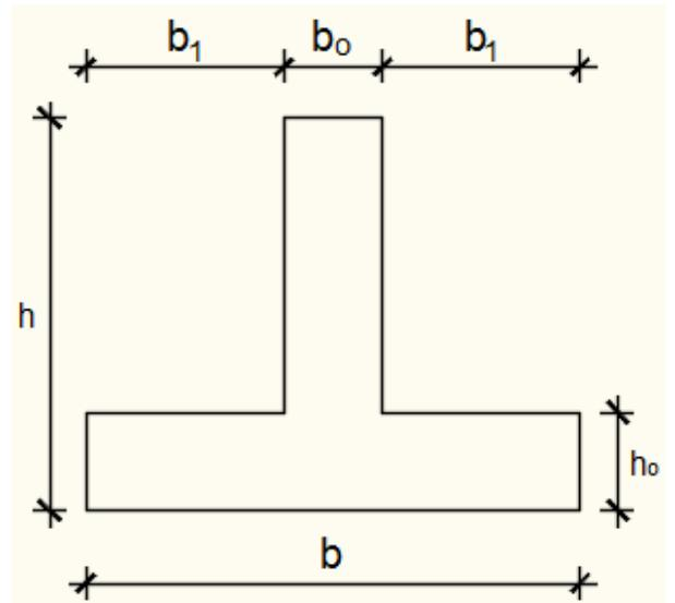
**Fig.IX.4:** dimension de la poutre.
