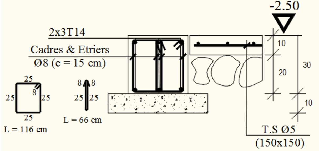
**Fig.IX.25 :** dessin de ferrailage de longrine.
