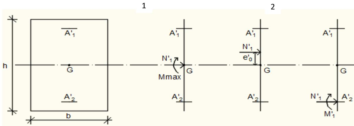
**Fig.VII.19:** Position de  $N'_1$ ,  $M'_1$  et  $M_1$  sur la section transversale.
