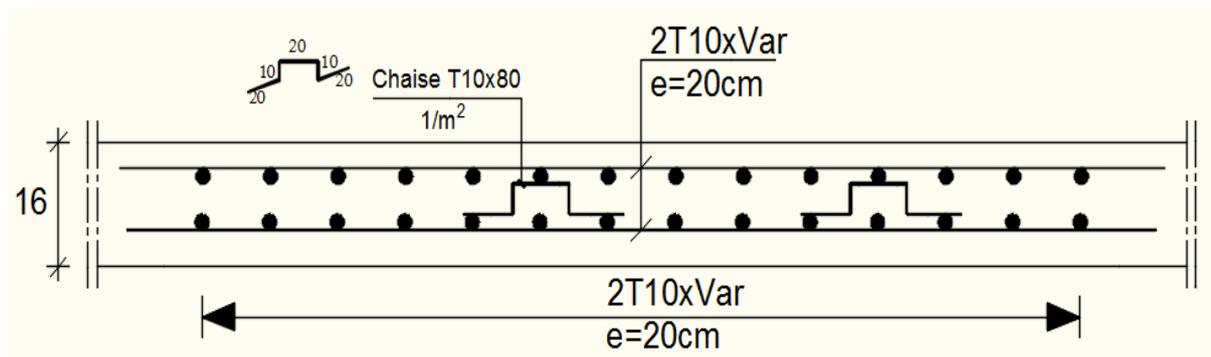
**Fig. IV.26** : Ferrailage de la dalle pleine.
