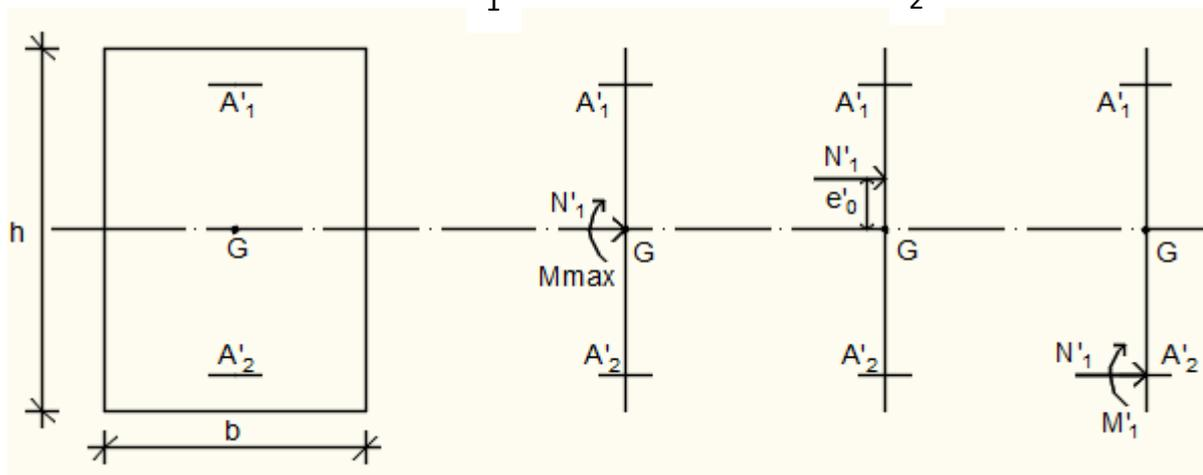
**Fig.VII.20:** Position de  $N'_1$   $M'_1$  et  $M_1$  sur la section transversale.
