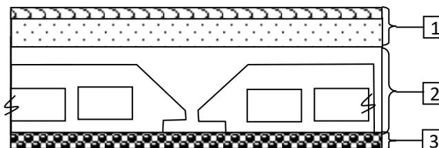
**Fig. II.5** : Coupe transversale du plancher étage courant
