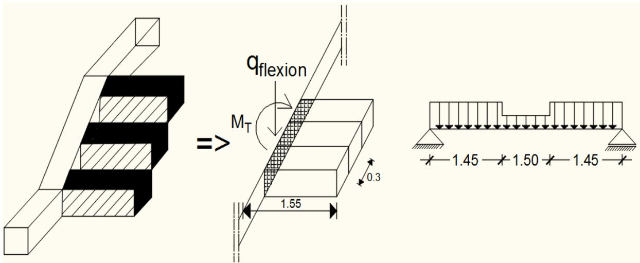
**Figure IV.1.19** : schéma des marches porteuses (effet de torsion).
