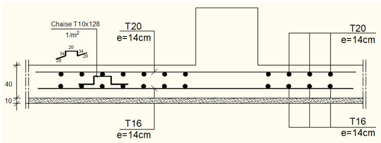
**Fig.IX.24** : ferrailage de la dalle de radier.
