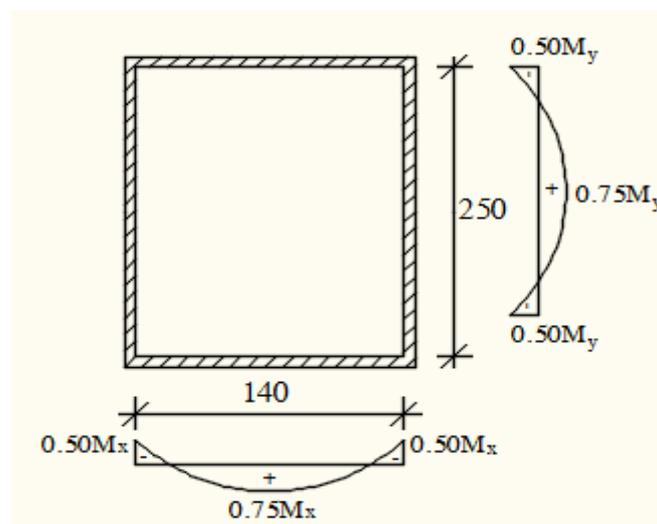
**Fig.V.5:** Schéma de panneau de dalle d'ascenseur.
