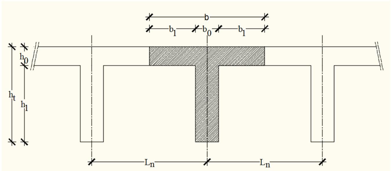
**Fig.III.2:** Schéma des poutrelles.
