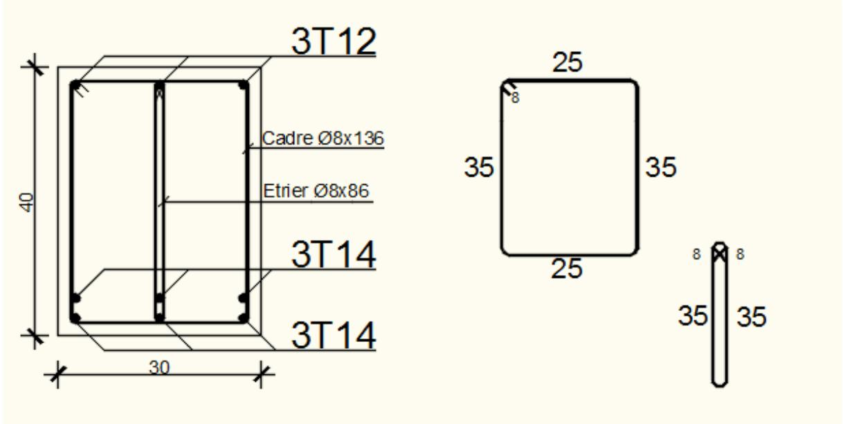
**Fig.IV.1.36:** Dessin de ferrailage de la poutre palier en travée.
