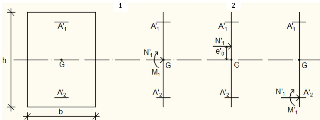
**Fig.VII.17:** Position de  $N'_1$ ,  $M'_1$  et  $M_1$  sur la section transversale.
