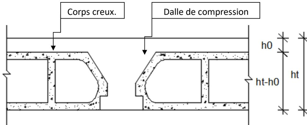
**Fig. II.2:** coupe transversale d'un plancher à corps creux.
