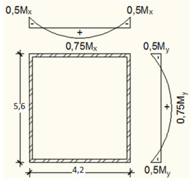
**Fig.IX.7:** Schéma du panneau de la dalle.
