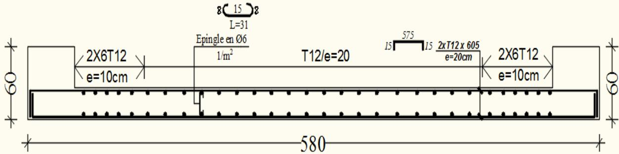
**Fig.VII.8** : Dessin du ferrailage du voile de contreventement.
