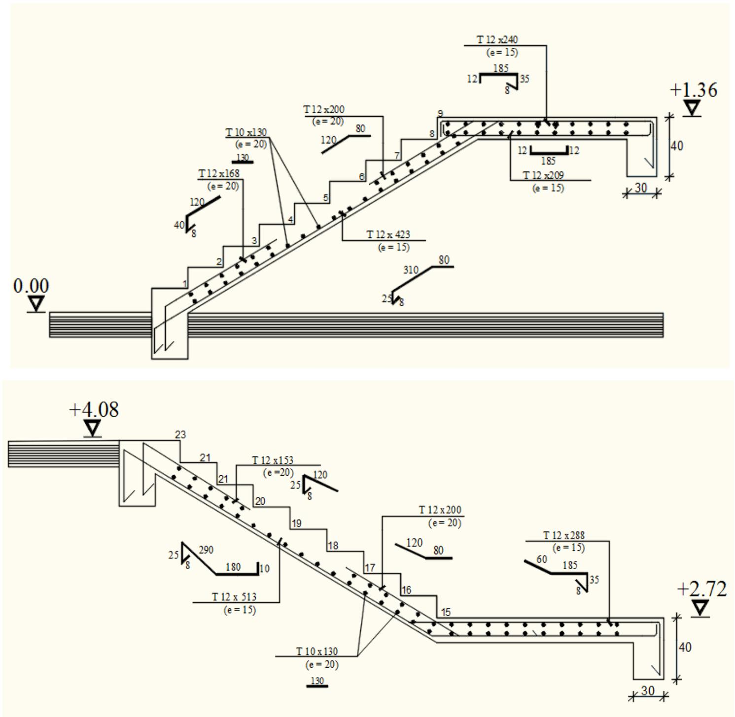
**Fig.IV.1.14:** Dessin de ferrillage de l'escalier à paillasse porteuse.
