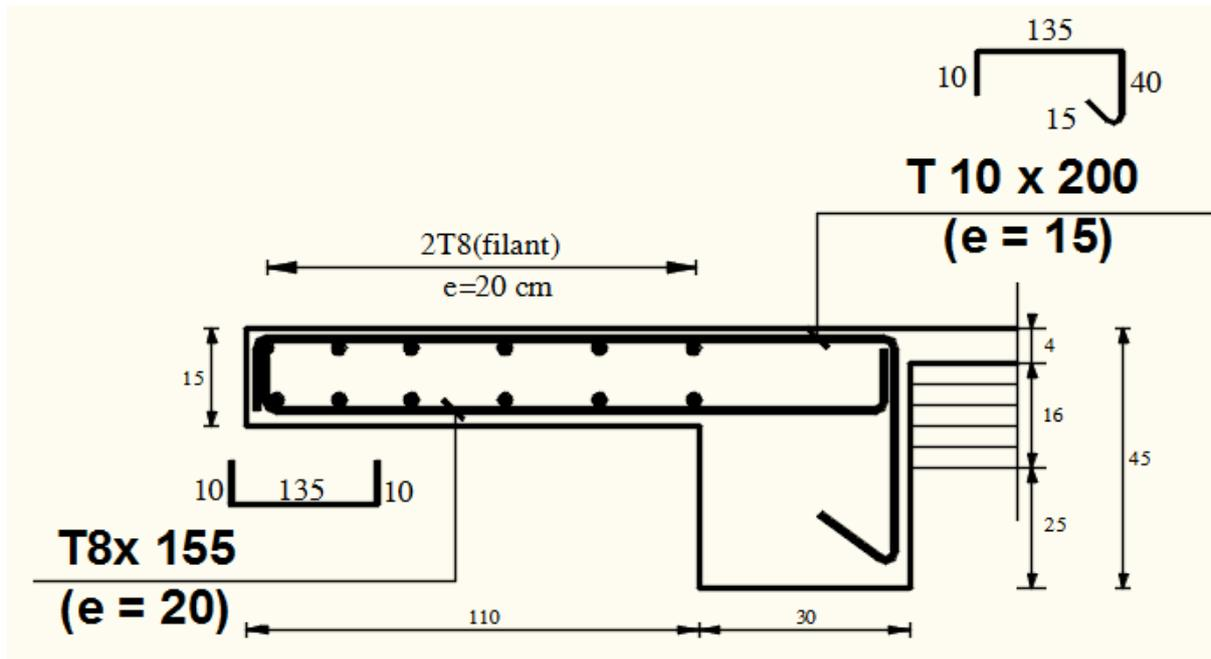
**Figure IV.2.7** : Schéma de ferrailage balcon type 1.
