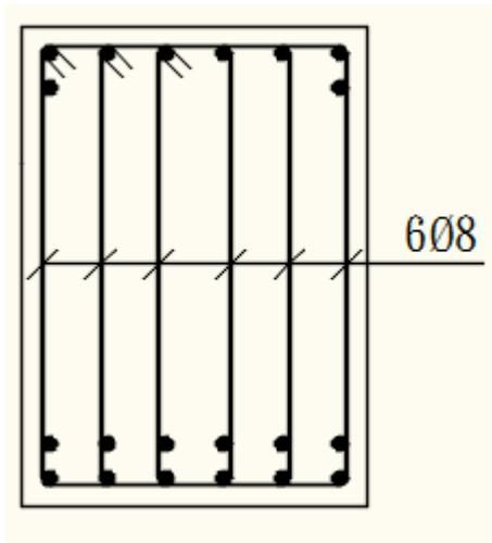
**Fig.IX.19** : Armatures transversales.
