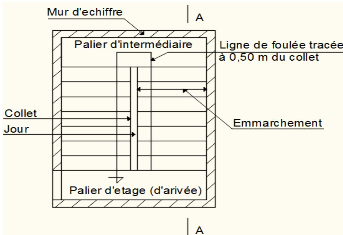
**Figure IV.1.1** : Vue en plan de la cage d'escaliers.
