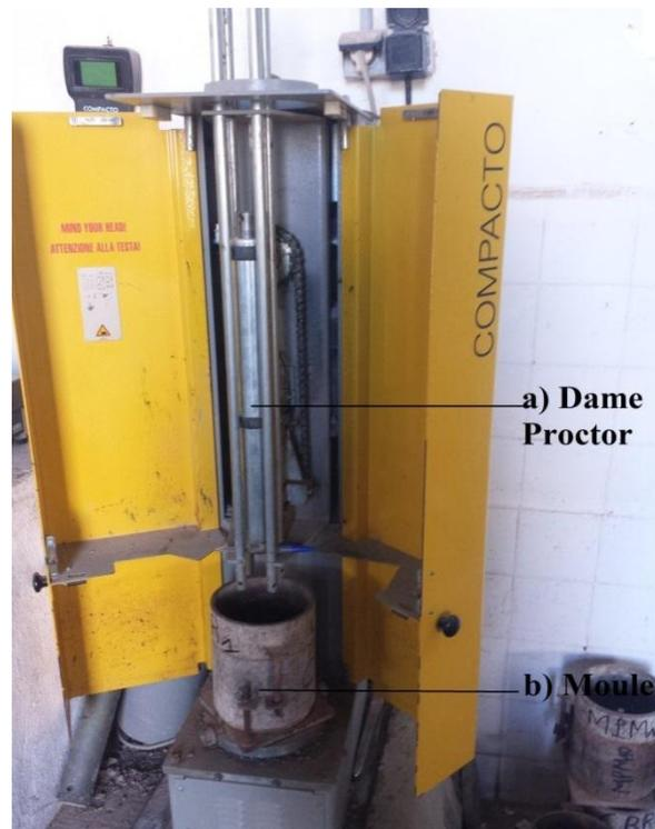
Figure II .15 : Machine de compactage pour l'essai Proctor
