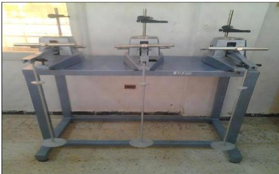
Figure II.11 : Appareillage de l'essai de compressibilité par palier à l'œdomètre
