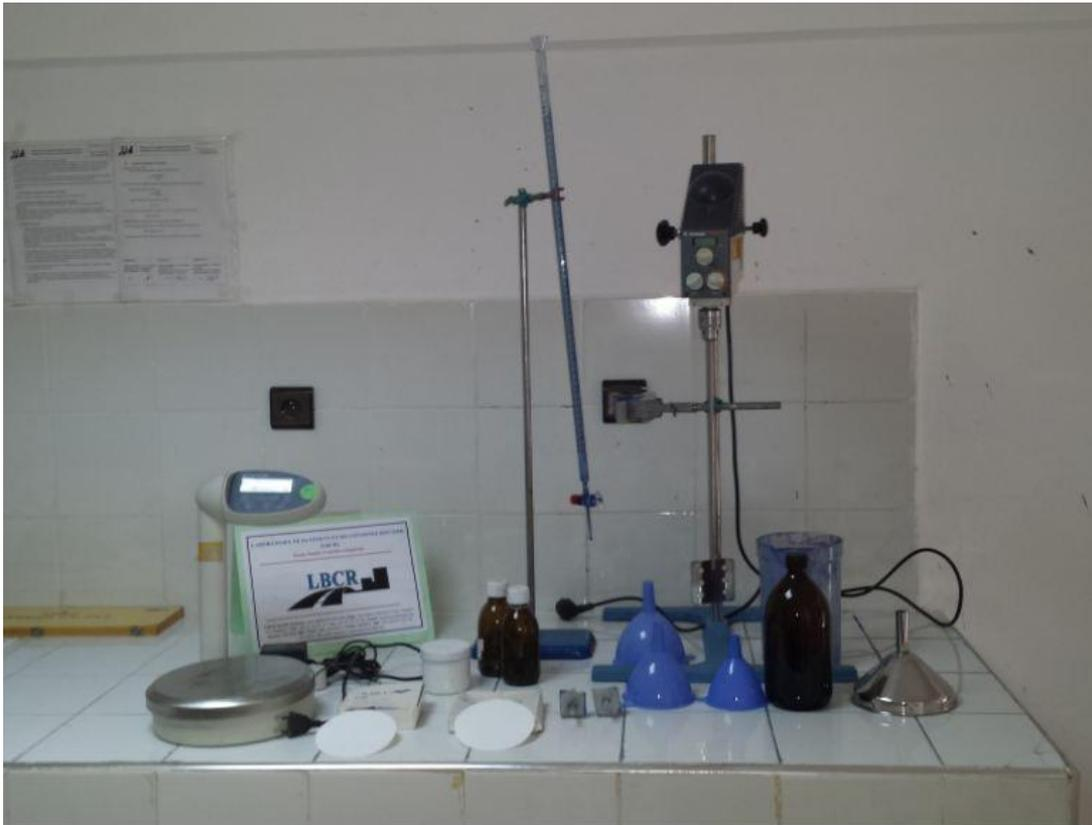
Figure II.7 : appareillage de l'essai bleu de méthylène
