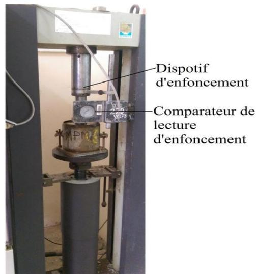
Figure II.17: Machine de poinçonnement à la presse CBR
