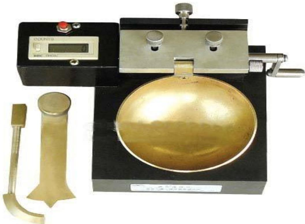
Figure II.5: appareil de Casagrande
