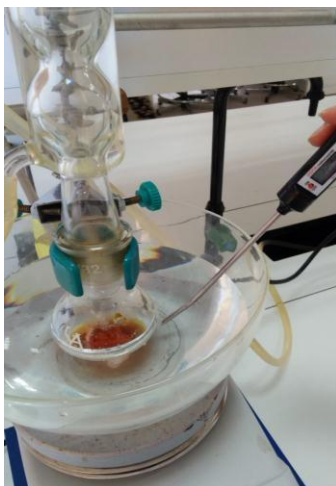
Figure III.9 : Dispositif de chauffage au bain marie.
