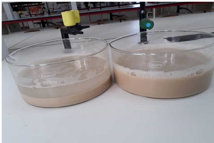
Figure N°16 : la décantation à l'air libre.
