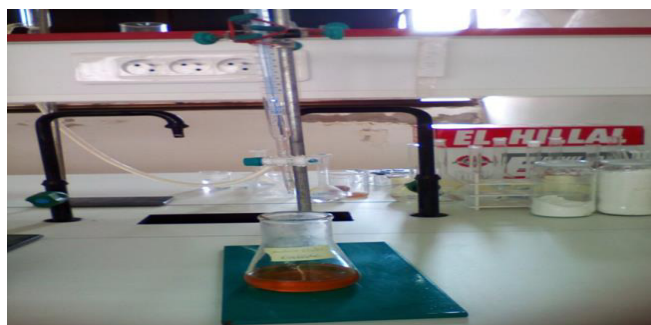
Figure18. Test d'indice d'ester
