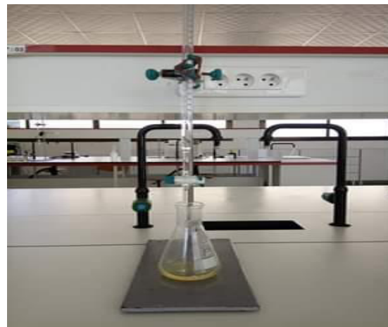
Figure17. Test d'indice de saponification
