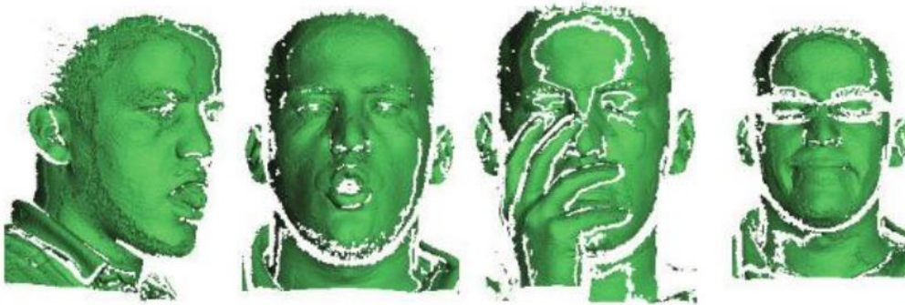
Figure II. 2. Les données manquantes dues aux auto-occultation et à l'absorption du rayon laser par des zones sombres du visage [20].
