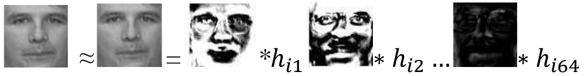
Figure IV-15 L'image la plus à gauche est l'image originale du visage et l'image reconstruite à l'aide des images de base (W) et le codage d'image correspondant ( h_i ) est affiché directement sur l'image d'origine.
