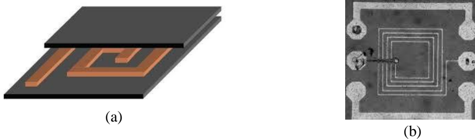
Figure I.11 : Inductance spirale planaire : a) vue 3D, b) Photographie de la réalisation.
