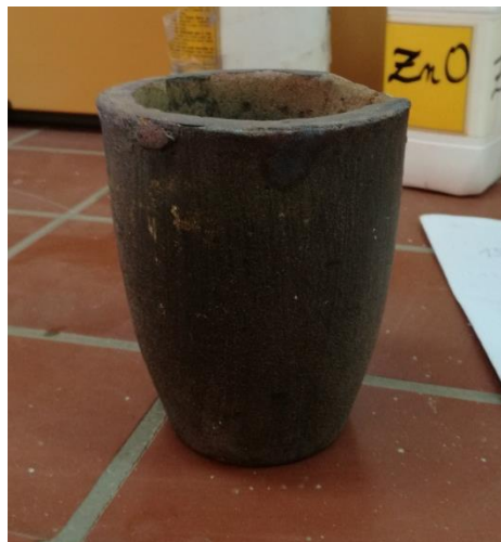
Figure-II-7. Creuset en graphite, contenance de 1litre.
