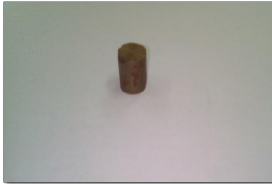
Figure III.13. L'éprouvette finie de la micro dreté.
