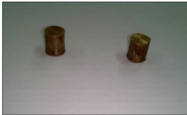
Figure III.12. L'éprouvette finie de la compression.
