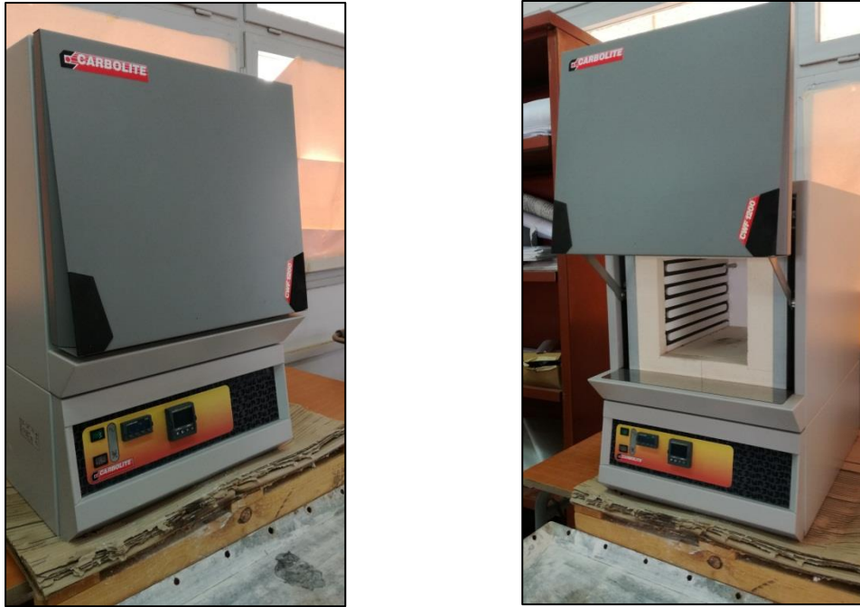
Figure-II-6. Four a chambre électrique.
