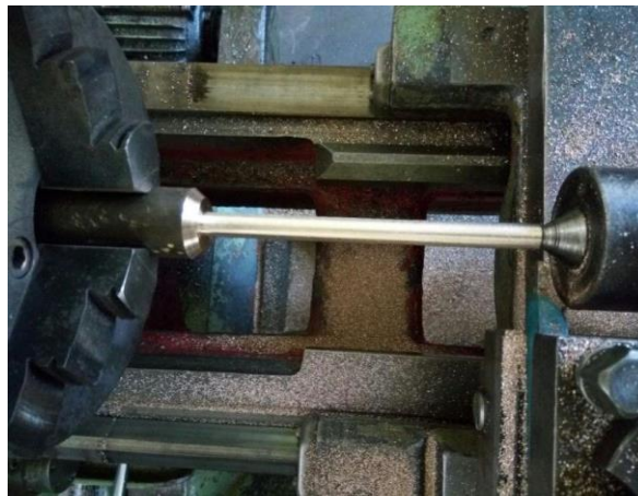
Figure III.10. Préparation de l'éprouvette de l'essai de traction.
