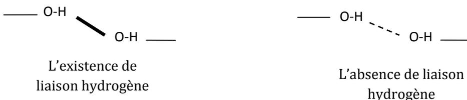
Figure 48 : Schéma donne un exemple de l'existence et l'absence de liaison hydrogène.
