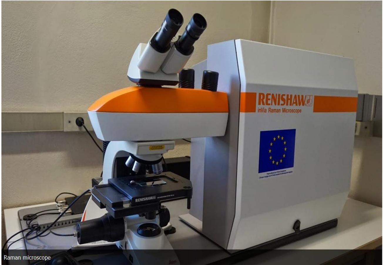
*Figure 23:* Photographie de spectromètre Raman (Renishaw InVia).
