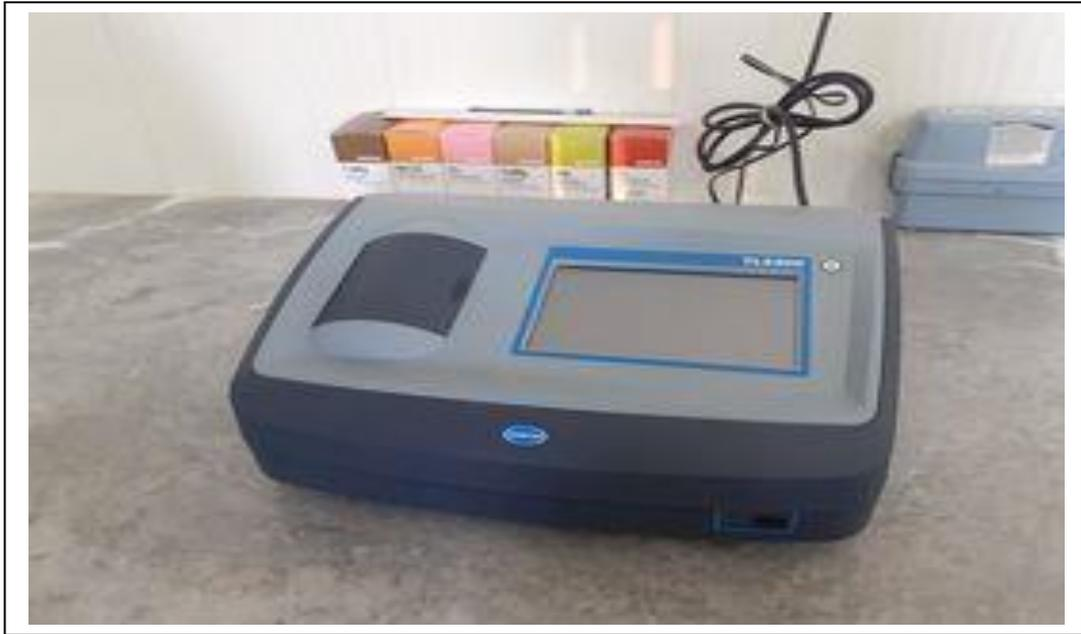
Figure 8 : Turbidimètre.
