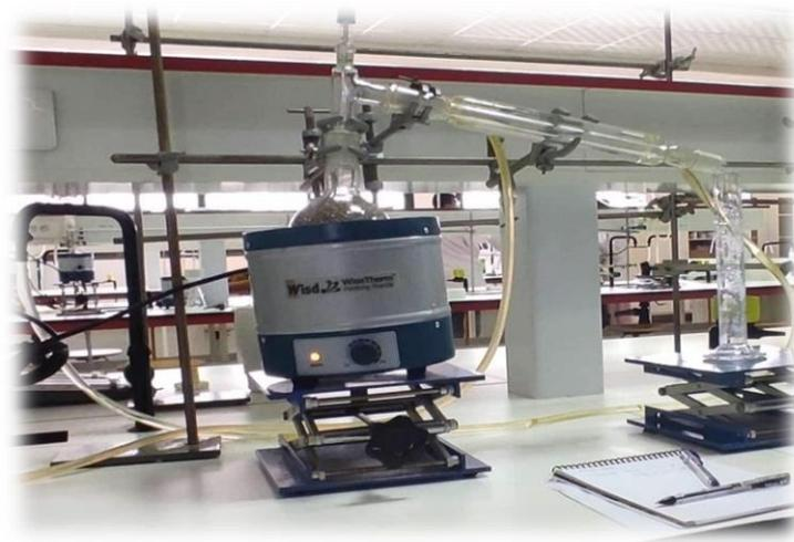
Figure 17 : Dispositif de l'hydro distillation à l'échelle du laboratoire.
