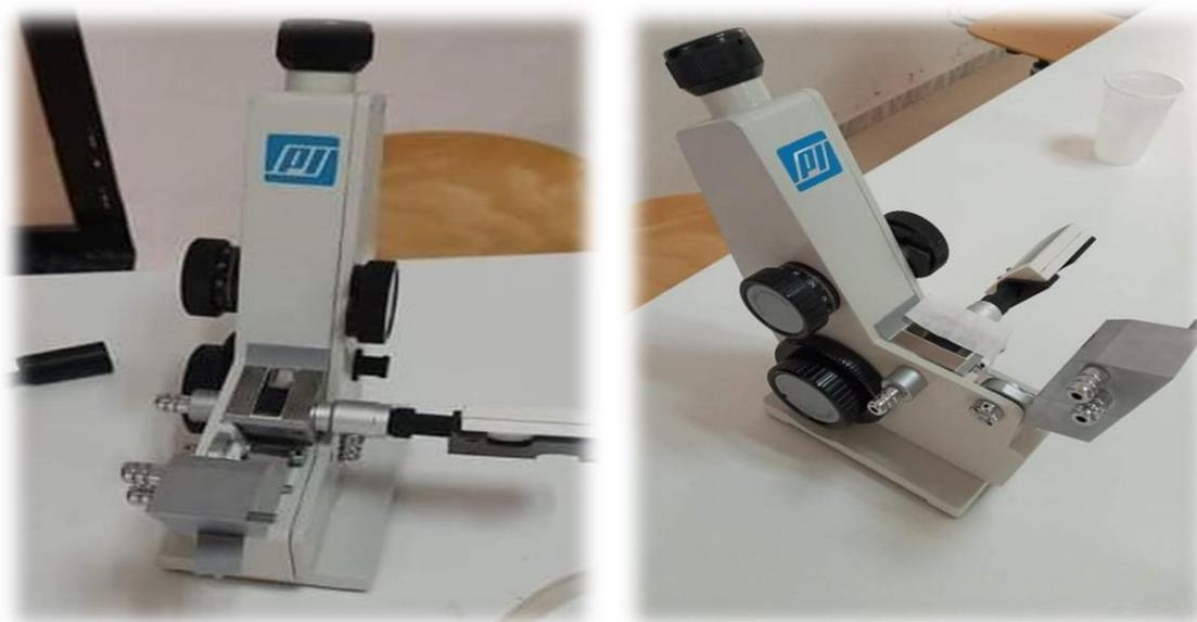
Figure 19 : Photo représente le réfractomètre.
