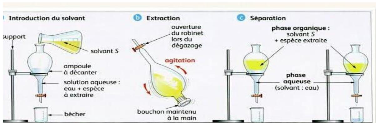
Figure.7 : schéma des procédés d'extractions par solvants <sup>(28)</sup>
