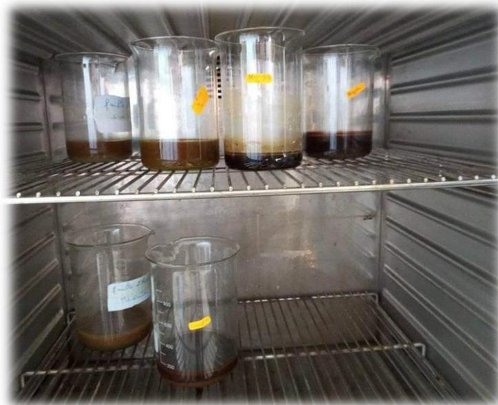
Figure 16 : évaporation à 50 °C dans l'étuve.
