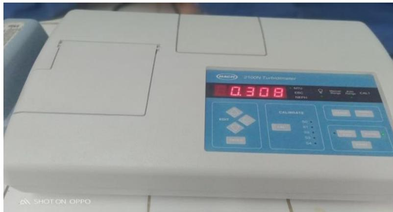
Figure 13: Turbidimètre
