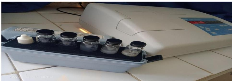
Figure14: Etalonnage de l'appareil de turbidité
