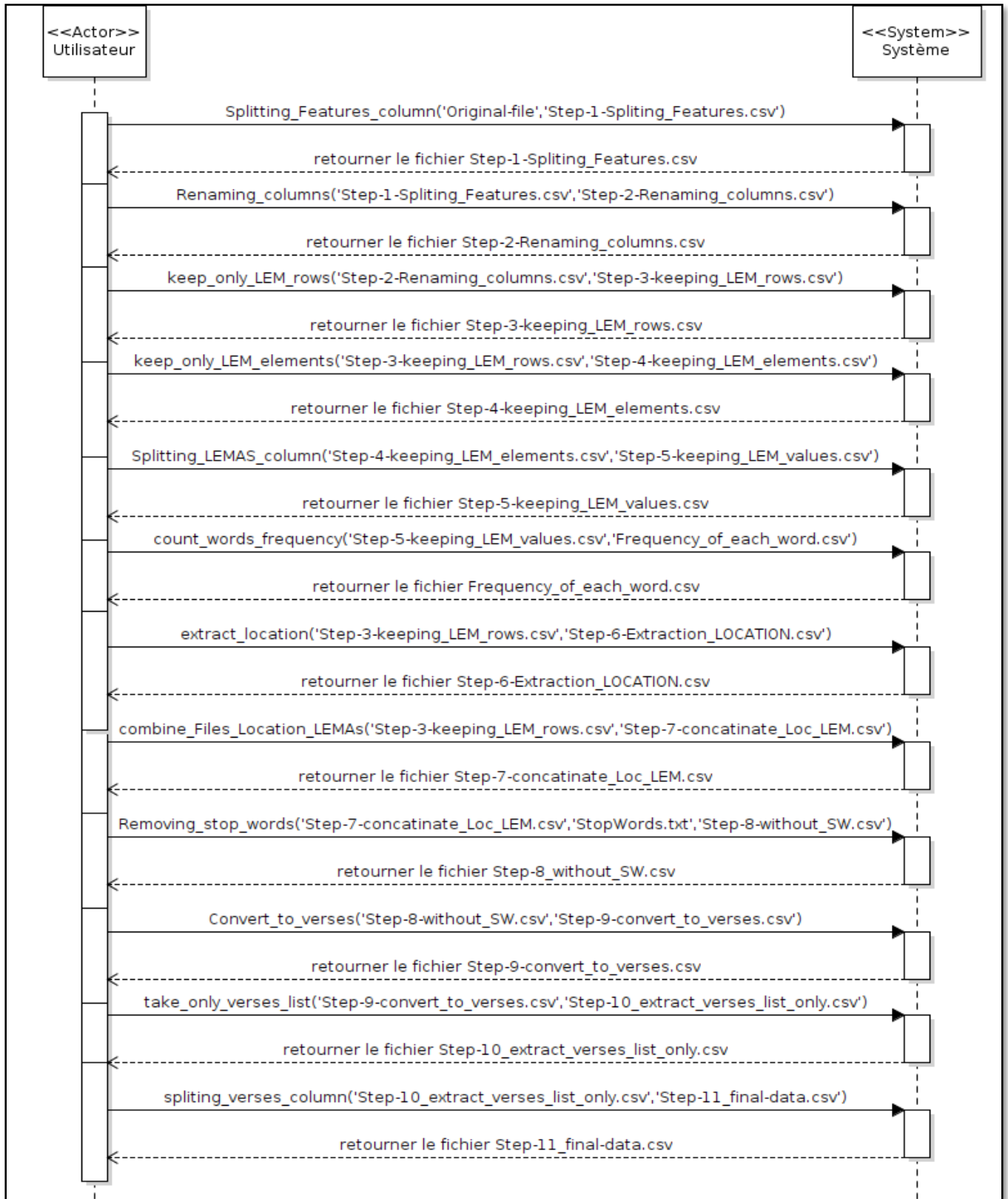
Figure 43 : diagramme de séquence d'enchaînement de prétraitement de données
