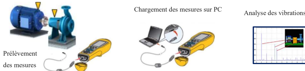
Figure 3.2 – Système de supervision hors-ligne
