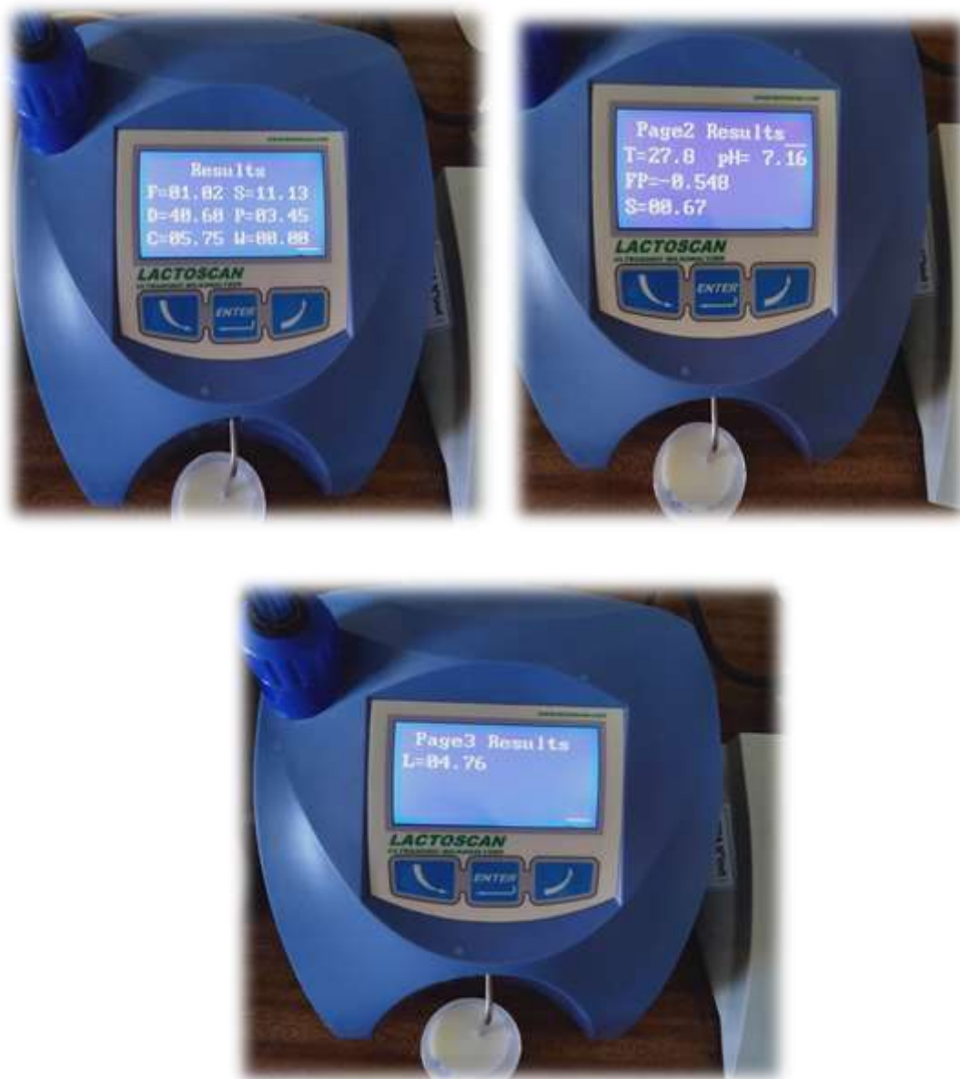
Figure 31. Résultats des analyses physico-chimiques du lait préparé partiellement écrémé établies par Lactoscan SP .
