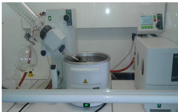
Figure 19: L'évaporateur rotatif BUCHE R-210
