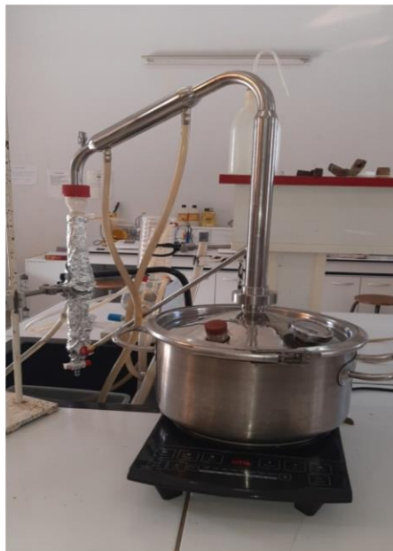
Figure 24: Dispositif d'entraînement à la vapeur d'eau (Originale, 2021)
