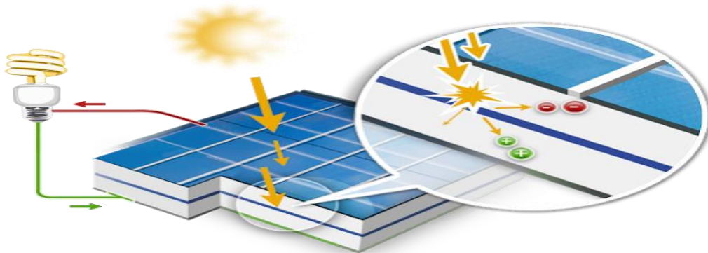
Figure I.6 : Le principe de fonctionnement d'une cellule solaire [13].
