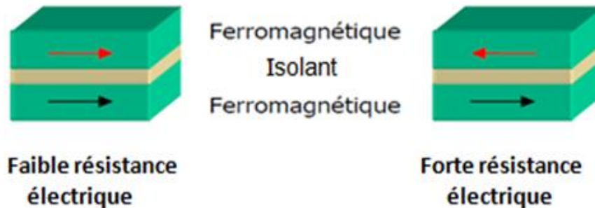
Figure I.6 : les deux états, parallèle et antiparallèle, dans une jonction tunnel magnétique
