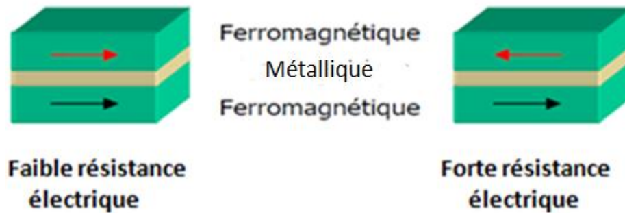
Figure I.5 : les deux états, parallèle et antiparallèle, dans une jonction géante magnétique.
