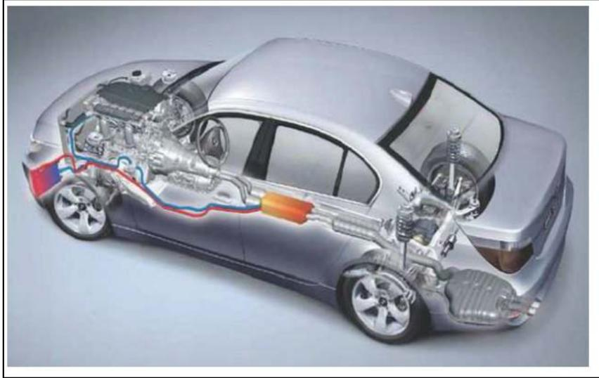
**Figure.I.4 :** Conception d'un générateur thermoélectrique produisant de l'électricité de la chaleur perdue au niveau du pot d'échappement d'un véhicule.
