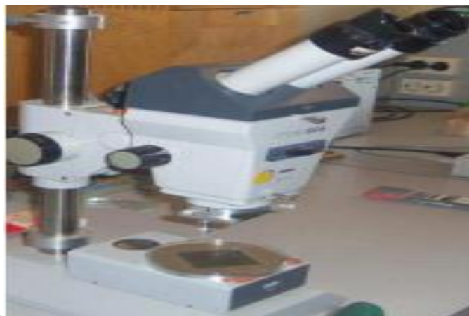
Figure I.2. Microscope pour le choix du monocristal
