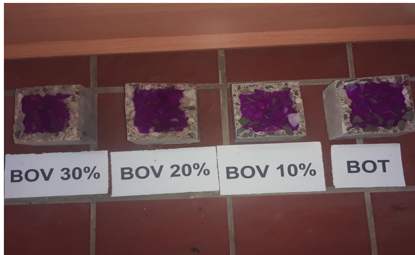
Figure III.9b : Carbonatation naturelle après 6 ans.
