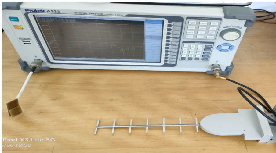
Figure IV.9 : La position des deux antennes Yagi et PIFA et la distance entre eux pendant la Lecture du paramètre S_{21} au niveau du VNA.
