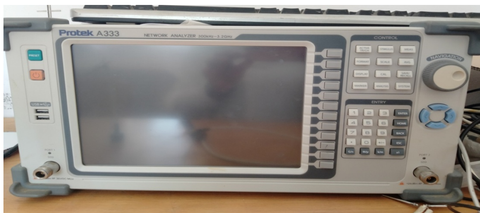
Figure I.1 : Vue avant de l'analyseur de réseaux vectoriels 3.2 GHz PROTEK A333 disponible au laboratoire du département de génie électrique.
