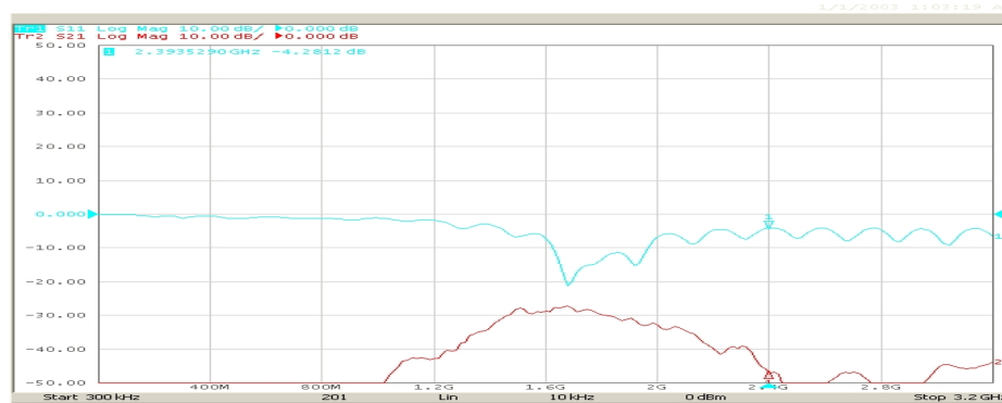
Figure III.15: Les coefficients S_{11} et S_{21} de l'antenne dipôle 1800 MHz prélevés du VNA PROTEK A333.
