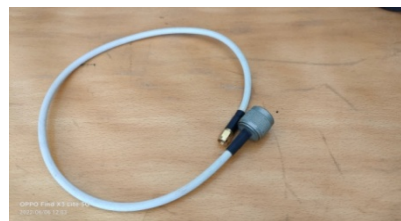
Câble coaxial d'interconnexion
