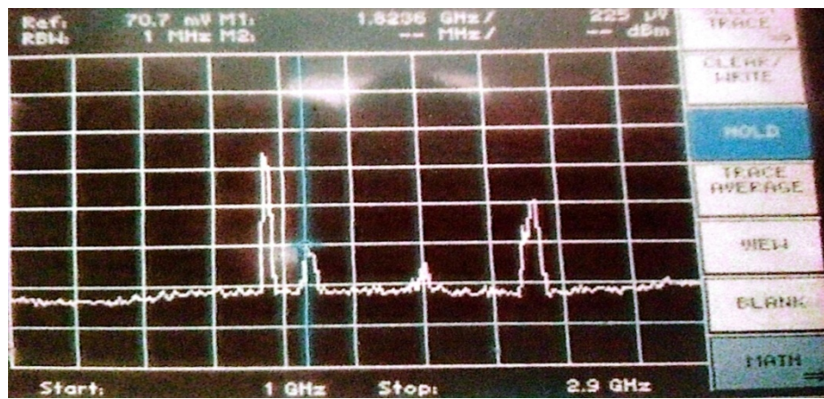
Figure III.19 : Pic de fréquence de la voie descendante localisé à f_D=1820 \text{ MHz} par l'antenne dipôle comme obtenu lors des tests au laboratoire signaux et systèmes.
