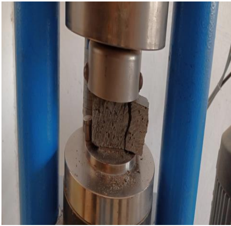
Figure II.23 : l'état des éprouvettes après la compression Figure II.24 : diagramme de compression
