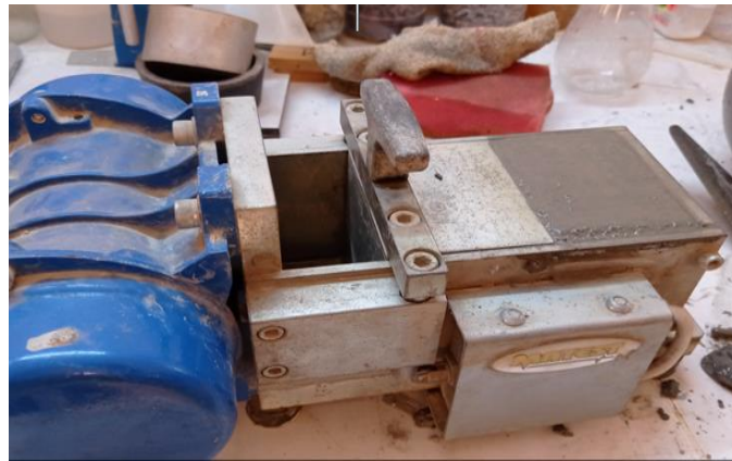
Figure II.7 : Maniabilimètre avec mortier
