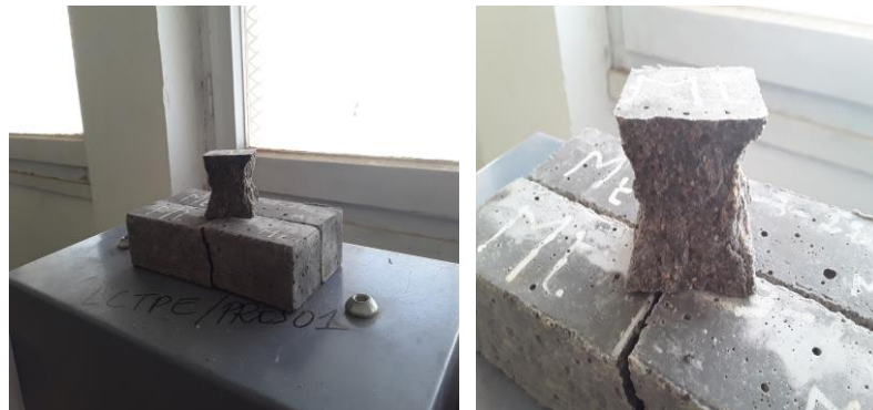
Figure II.25 : la forme d'éprouvette après essai de la compression
