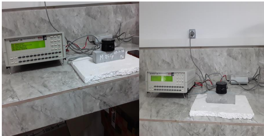
Figure II.29: Conductivimètre au laboratoire avec le mortier d'ENPO
