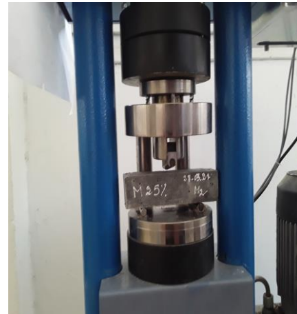
Figure II.19: l'éprouvette de 25% en flexion simple
