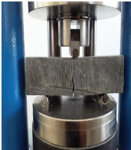
Figure II.20: le résultat de rupture de l'éprouvette
