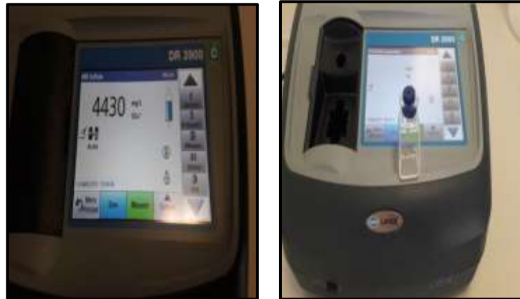
Figure III.4: Spectromètre pour la mesure de sulfate et TSS.
