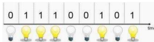
Figure II .2 : Principe de fonctionnement des LEDs en tant qu'émettrices d'un signal binaire.
