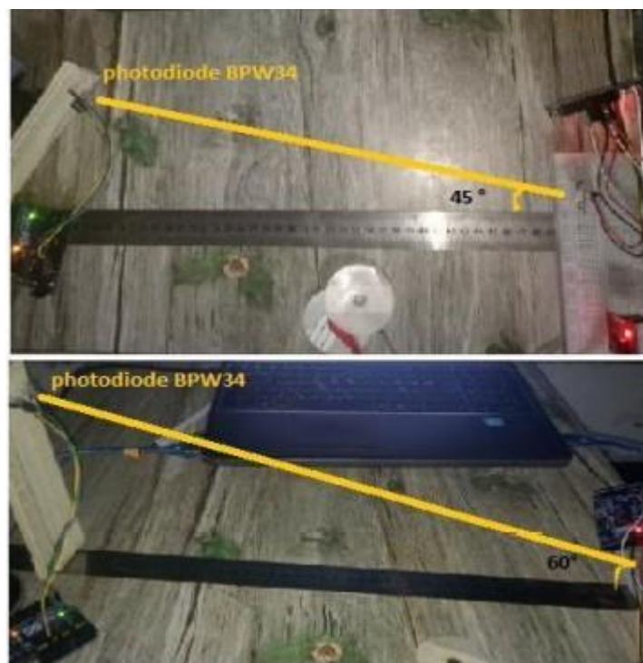
Figure III.25: Mesure de distance et d'angle réceptrice d'une photodiode.
