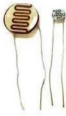
Figure III.5: La photorésistance LDR utilisée à la réception.
