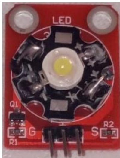
Figure III.4: Module LED 3W utilisé à l'émission.
