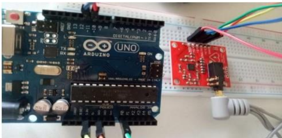
Figure III.13 : Connexion de l'Arduino avec le capteur ECG AD8232.
