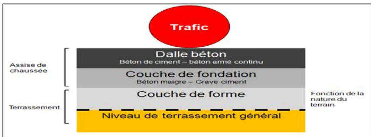
Figure VII.3 : Structure type d'une chaussée rigide.
