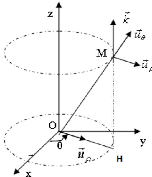
**Figure 18 :** Coordonnées d'un point M dans un repère cylindrique.
