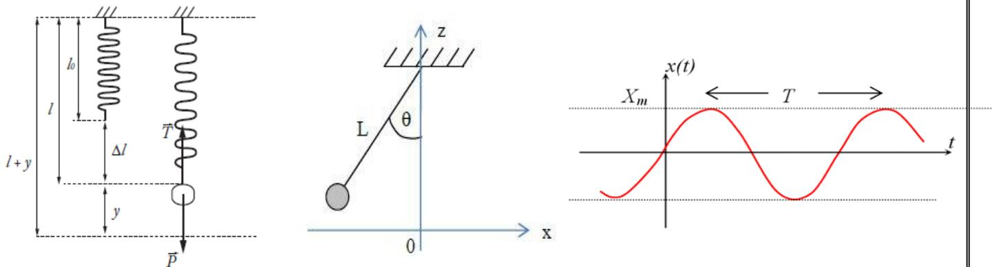
Figure 15 : Mouvement rectiligne sinusoïdal.
