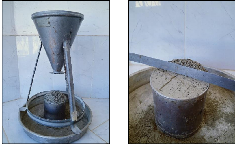
Figure I.1. La masse volumique apparente du ciment.
