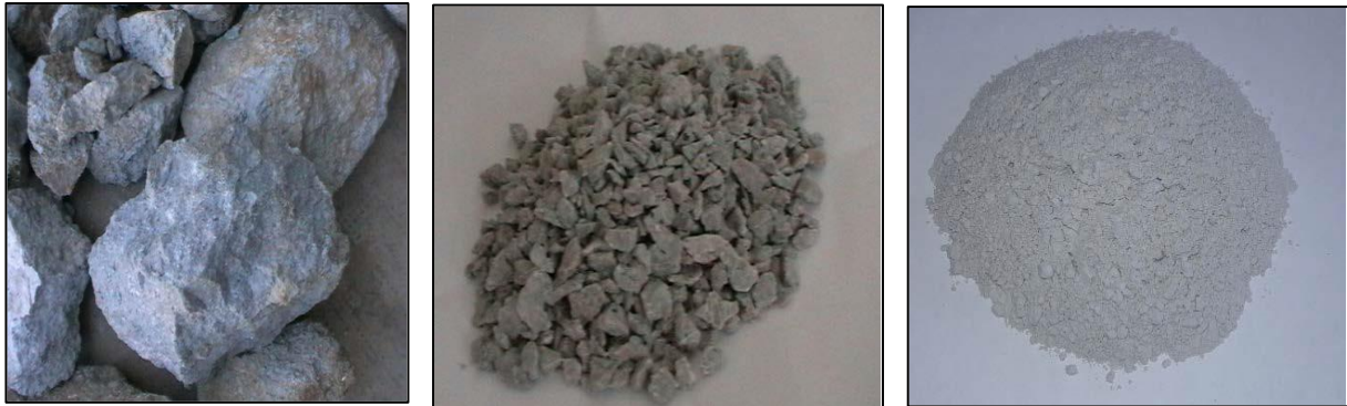
Figure I.5. Perlite naturelle (a), concassée (b), broyée (c)(17)
