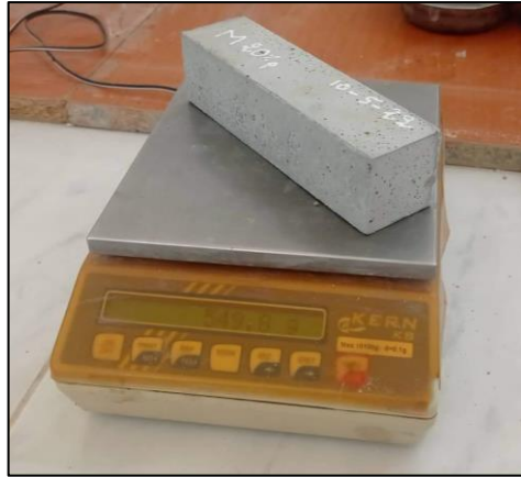
Figure II.10. La pesée des éprouvettes après 7 jours.
