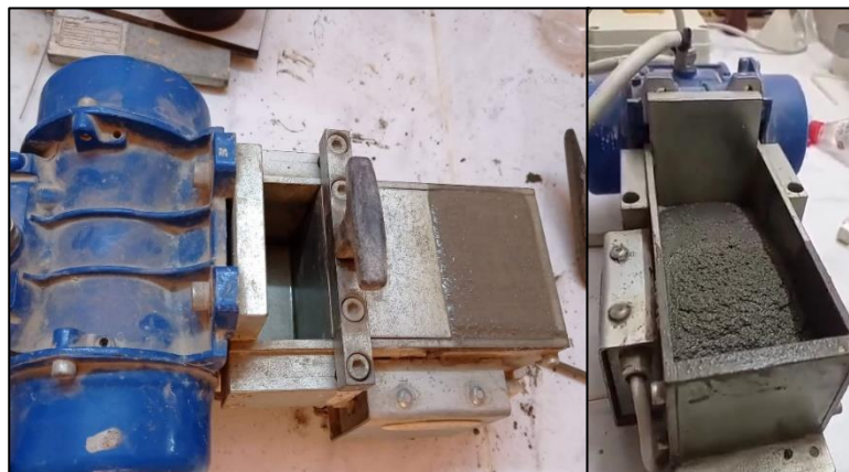
Figure II.5. Procédure de l'essai de maniabilité.
