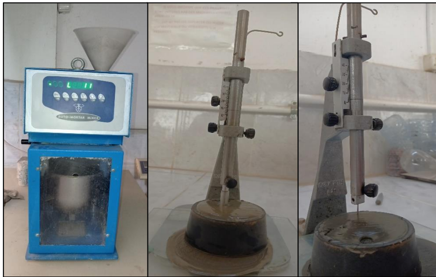
Figure II.1. Essai de consistance et de prise avec appareil de Vicat.
