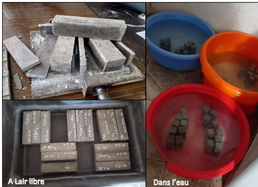
Figure II.8. Les éprouvettes après démoulage et conservation.
