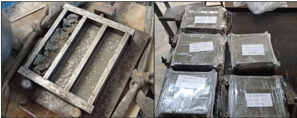
Figure II.7. Remplissage d'éprouvettes prismatiques (4x4x16) cm 3
