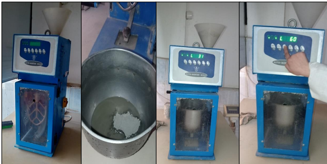
Figure II.6. Les étapes du malaxage du mortier.
