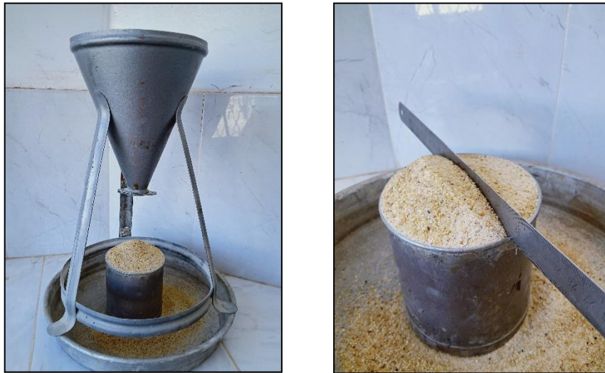
Figure I.6. La masse volumique apparente du sable.
