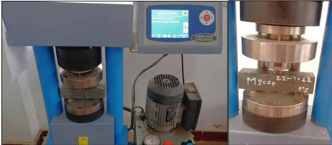
Figure II.12. Machine d'essais de résistance à la traction
