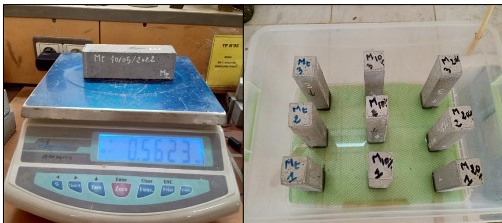
Figure II.9. Eprouvettes dans le récipient en position verticale avec un niveau d'eau constant de 3mm.
