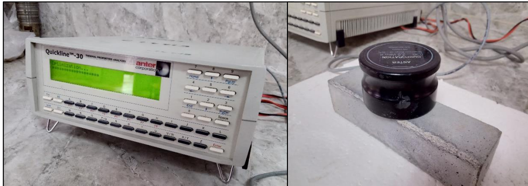
Figure II.11. Conductivimètre au laboratoire LABMAT
