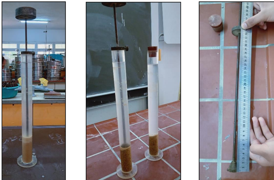
Figure I.8. Équivalent de sable avec piston.
