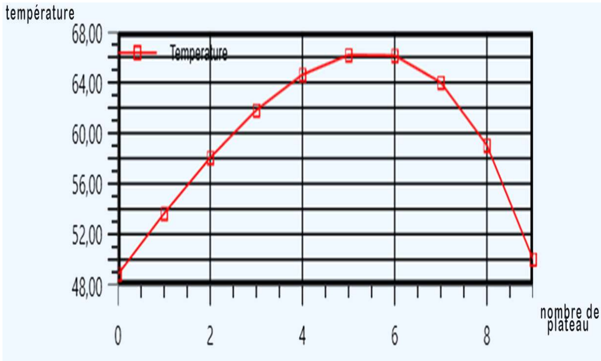
Figure II.14 : Evolution de la température en fonction du nombre de plateaux dans l'absorbeur.
