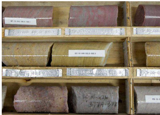
Figure n°38 : Exemple d'un essai de carottage.
