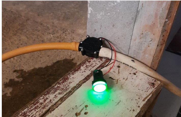
Figure III-9 : une lampe allumée par la turbine
