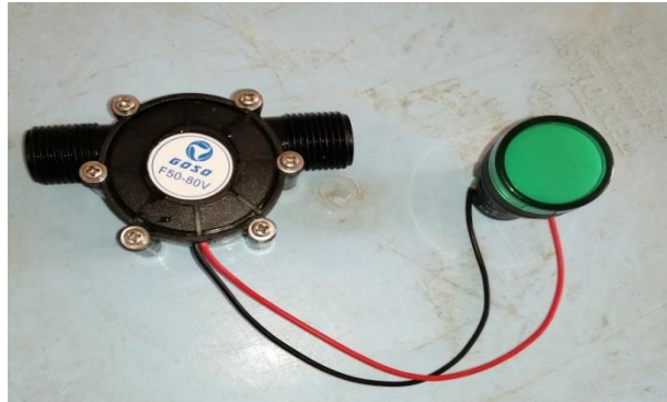
Figure III-4 : Micro-turbine avec une lampe
