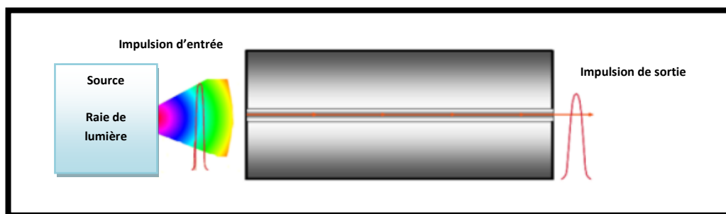
Figure 1.2 : Fibre optique monomode [7].
