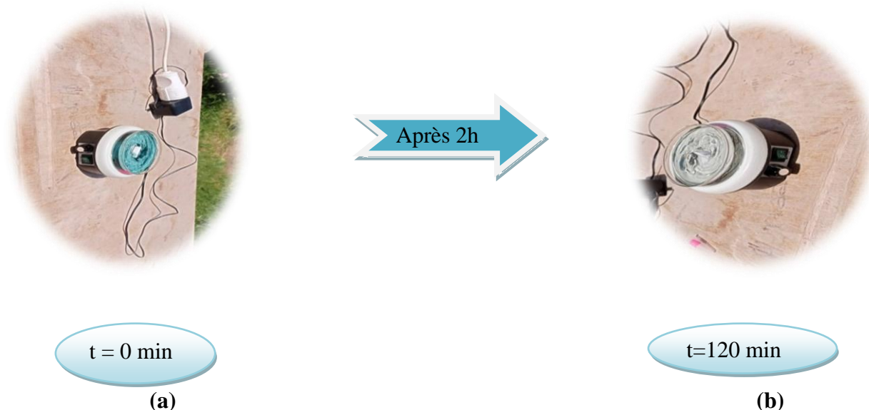
figure 11: Activité photocatalytique contre le bleu de méthylène (a) Avant irradiation et (b) Après irradiation.
