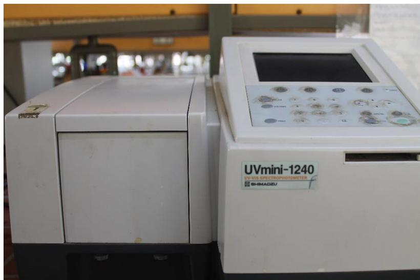
Figure IV.1 : Appareil spectrophotométrie UV-Visible
