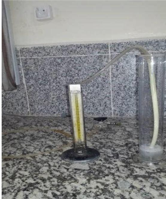
**Figure 03 :** Appareil de mesure de moussage
