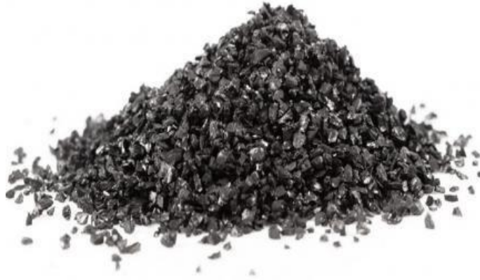
Figure 6: Le charbon actif granulé (CAG).
